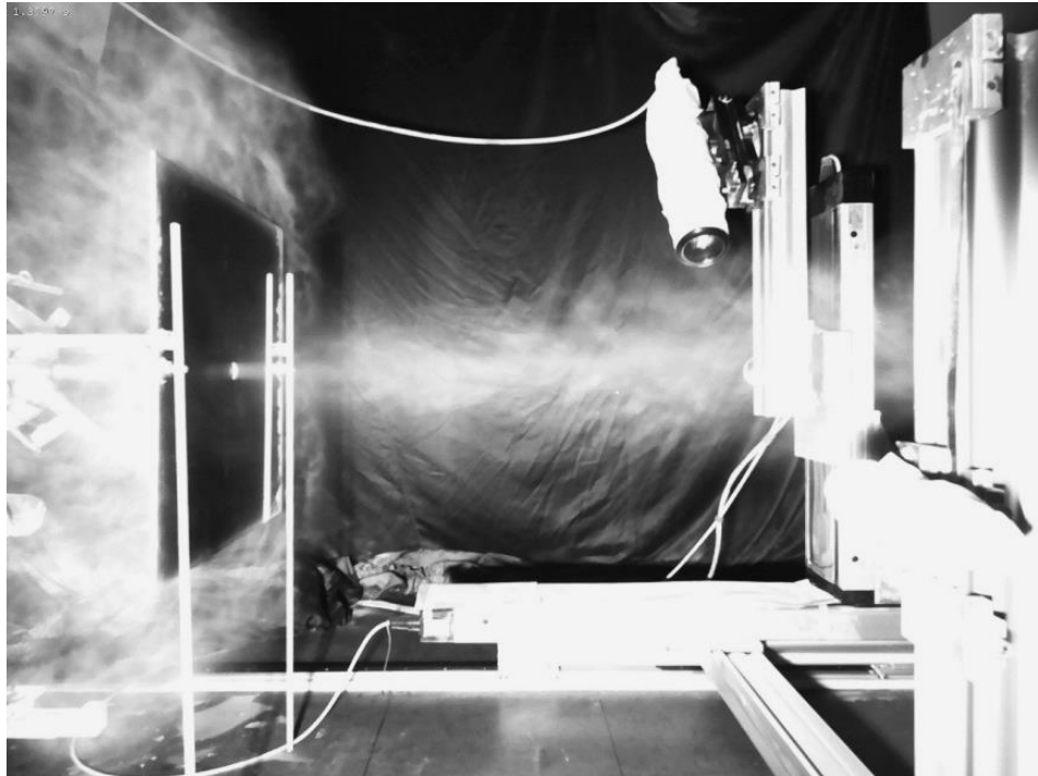
Abb. 6.47 Einzelbild der Hochgeschwindigkeitsaufnahme des Freistrahls und des von der Lochblende zurückgehaltenen Anteils bei Versuch 221, 0,07 s nach Beginn der Öffnung
