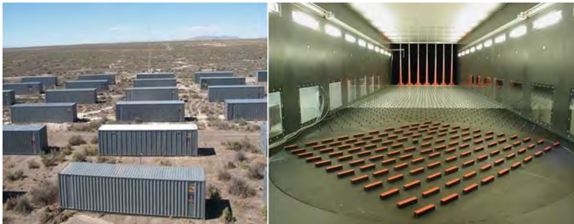
Abb. 3.1 Bilder von dem originalen Feldexperiment in der Wüste von Utah und dessen Nachbildung im Windkanal WOTAN in Hamburg (Bild aus /SCH 10/)
