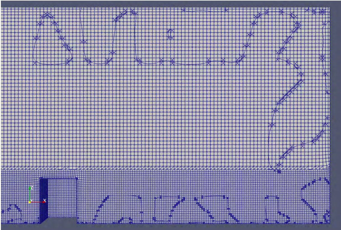
Abb. 2.16 Schnitt durch das mit cartesianMesh erzeugte Rechengitter
