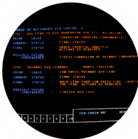
Bild 22: Darstellung der Alarmmeldungen auf dem Bildschirm
