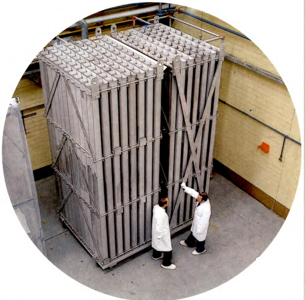
Bild 34: Kompaktlagergestell zur Lagerung von abgebrannten Brennelementen
