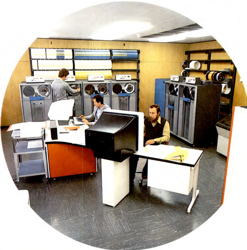
Bild 3: Bedienungskonsole und Magnetband-Peripherie
