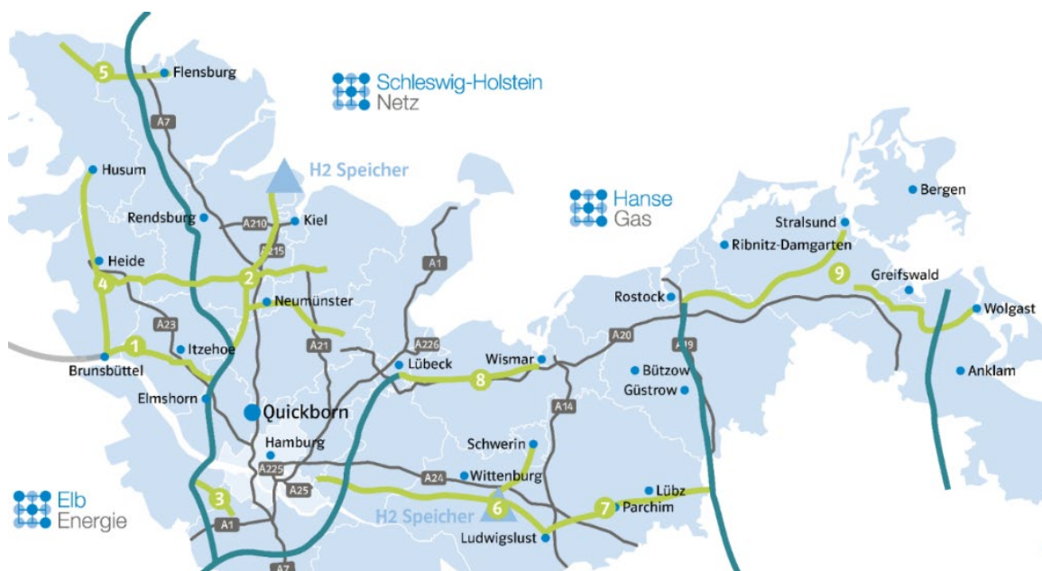
Abbildung 35: Planung für H 2 Hanse Netz (grüne Linien) und European Hydrogen Backbone (blaue Linien) (Quelle: Schleswig-Holstein Netz)
