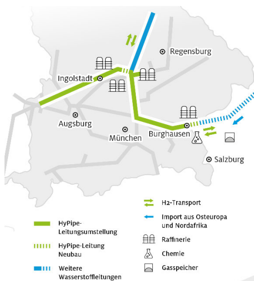
Abbildung 30: Geplanter Trassenverlauf HyPipe Bavaria (Quelle: bayernets)
