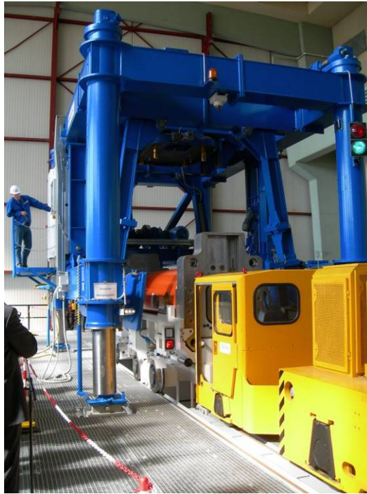
Abb. 5.10 Einlagerungsvorrichtung übernimmt den Transferbehälter
