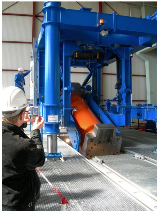
Abb. 5.11 Aufrichten des Transferbehälters
