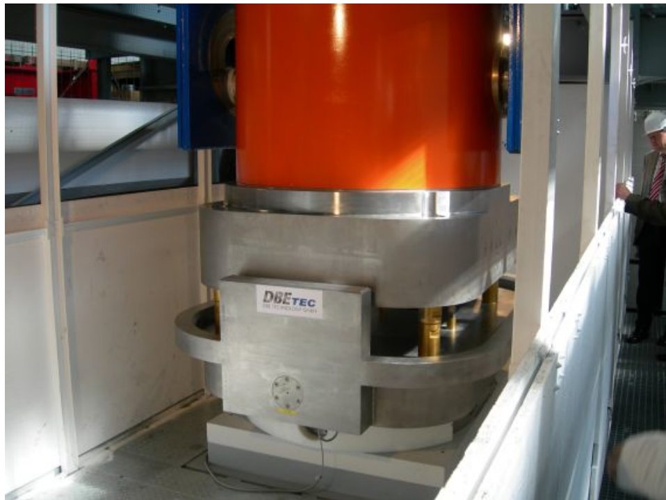
Abb. 5.13 Einstellen des Transferbehälters auf die Bohrlochschleuse
