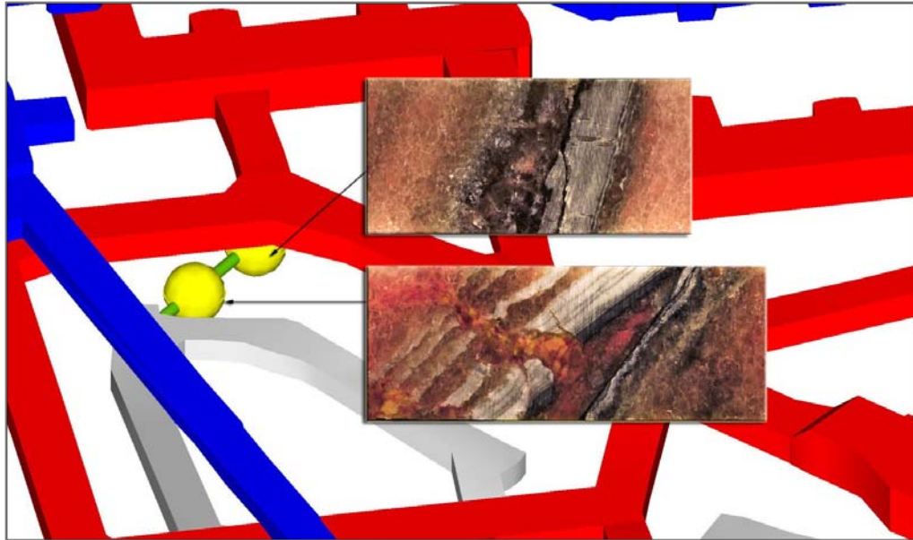
Abb. 3.21 Lage der Gorleben-Bank-Bohrung 01YEA02RB754 im Grubengebäude und Ausbildung der in dieser Bohrung angetroffenen Gorleben-Bank-Durchgänge
