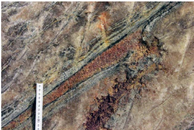
Abb. 3.12 Aufschluss der Gorleben-Bank mit deutlichen Anzeichen einer Deformation
