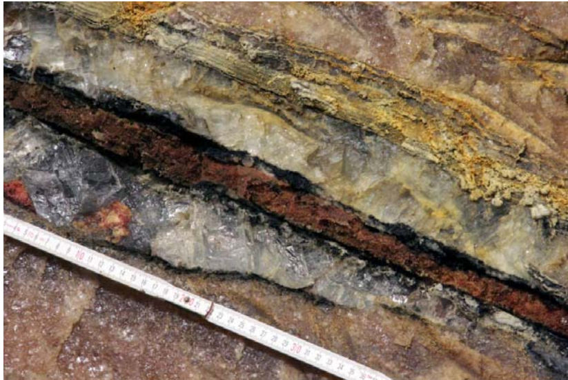
Abb. 3.11 Ausbildung der bei der Halokinese im Bereich der Zone III aufgerissenen und durch sekundäre Halite (farblos) und Carnallite (rot) wieder verheilten Gorleben-Bank
