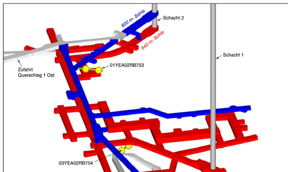
Abb. 3.18 Lage der beiden Gorleben-Bank-Bohrungen 01YEA02RB753 und 03YEA02RB754 im Grubengebäude des Erkundungsbergwerkes Gorleben mit jeweils zwei Gorleben-Bank-Durchgängen (gelbe Kugeln)
