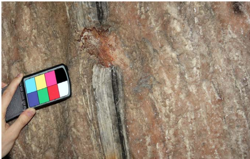
Abb. 3.10 Boudinage an einem ca. 10 cm mächtigen Gorleben-Bank-Aufschluss im Ergebnis intensiver salztektonischer Beanspruchung
