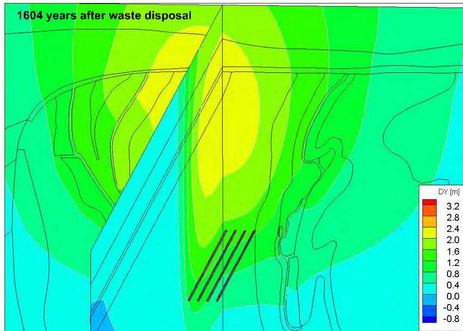
Abb. 4.37 SLB1-3D Vertikalverschiebung nach 1.604 Jahren (3D-Darstellung mit den Einlagerungsstrecken – Halbmodell mit Symmetrieebene)
