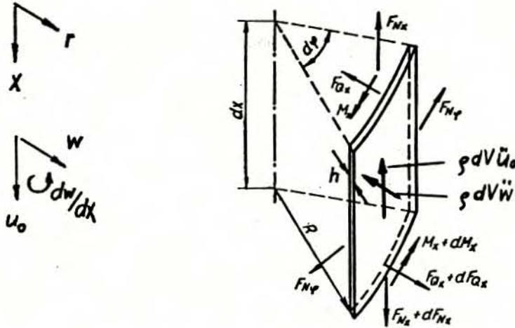
Abb. 12: Dynamisches Gleichgewicht des Volumenelementes
