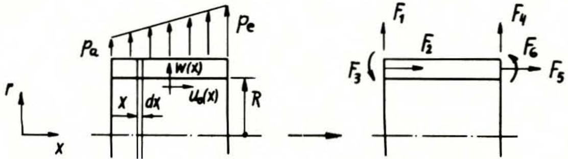
Abb. 9: Rohrelement mit offenen Enden
