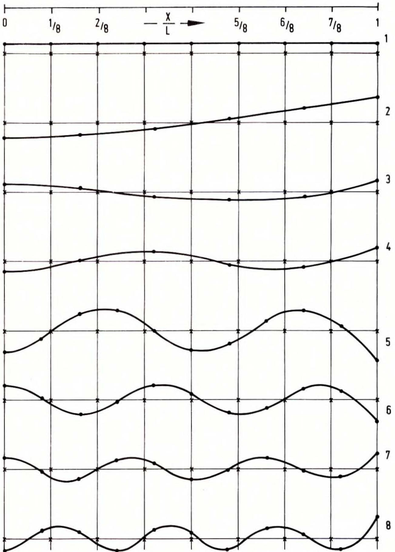
Abb. 14: Ortsfunktion  $F(x)$  der Schalenschwingung
