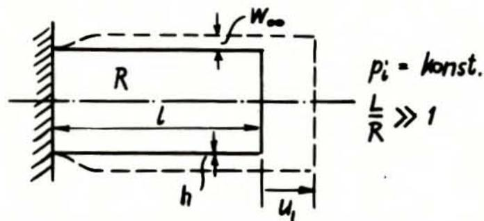
Abb. 7: Beispiel des Rohres unter Innendruck
