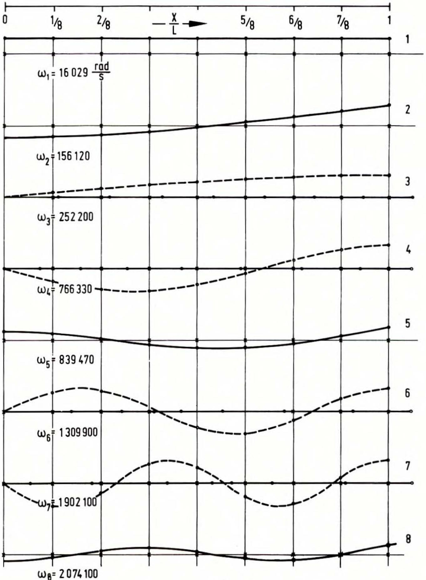
Abb.16: Eigenformen  $\underbrace{v=0,0 \quad v=0,3}_{\approx} \quad \frac{L}{R} = 0,1; 8 \text{ Elemente}$
