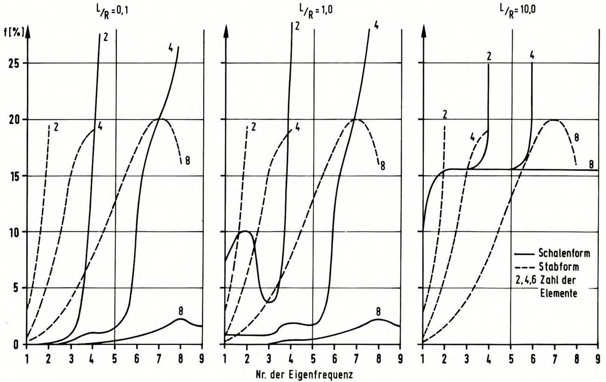
Abb. 21: Abweichung der Eigenfrequenzen gegenüber der Analytik
