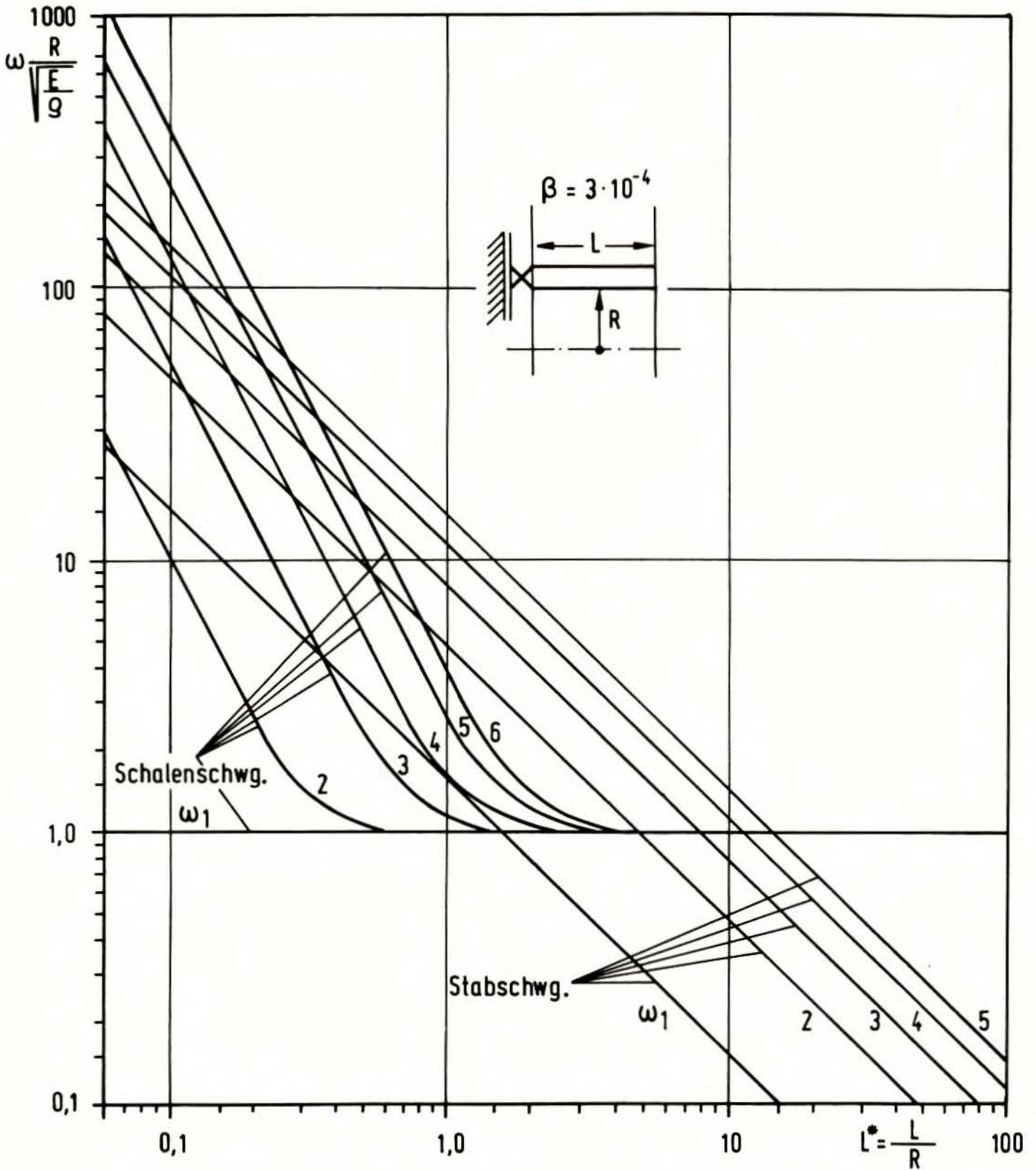
Abb.13: Dimensionslose Eigenfrequenz  $\omega \sqrt{\frac{R}{Eg}}$  als Funktion der dimensionslosen Länge  $L^*$
