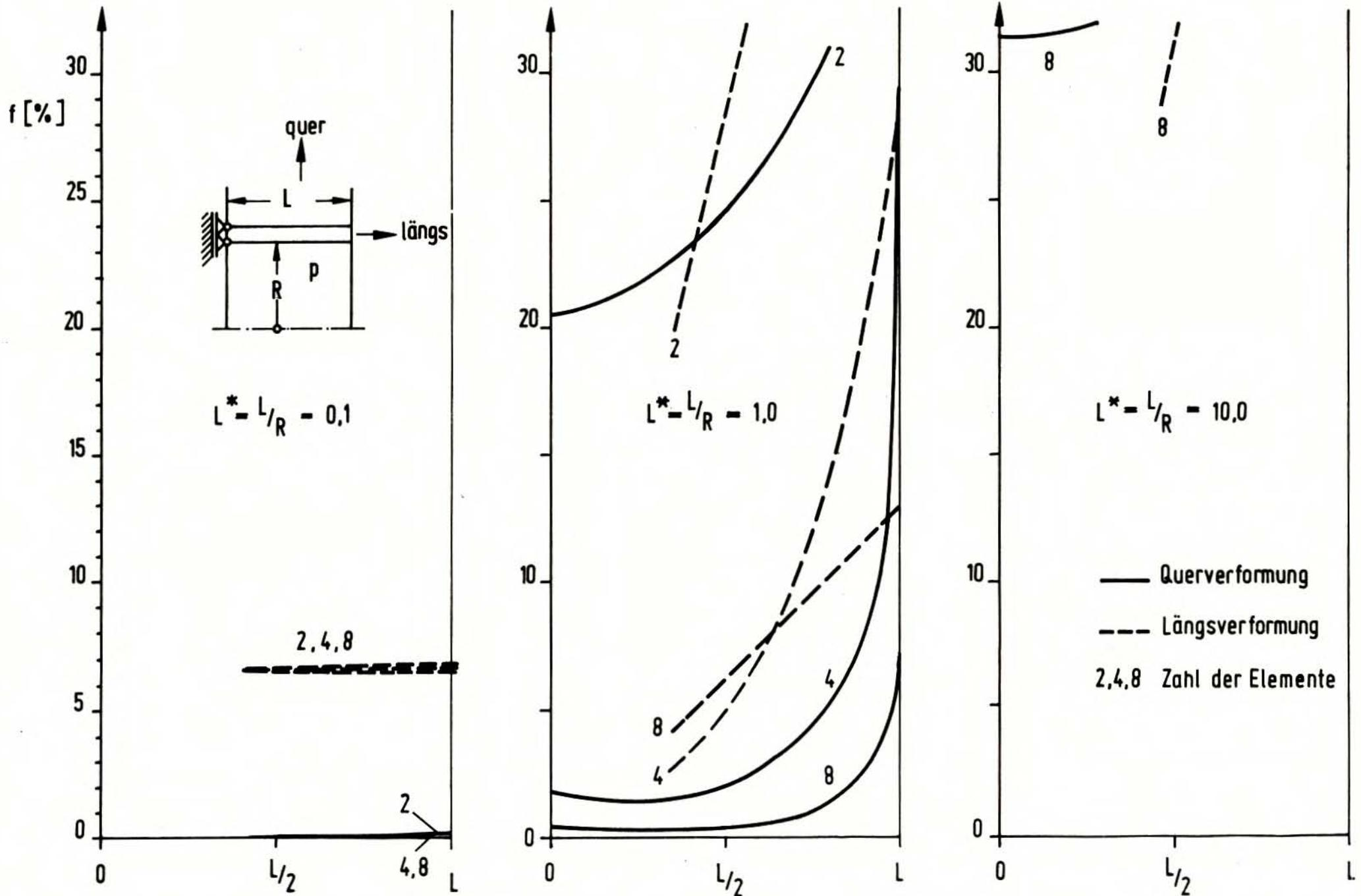
Abb. 23: Fehler der statischen Verschiebung des SAP IV-Elementes
