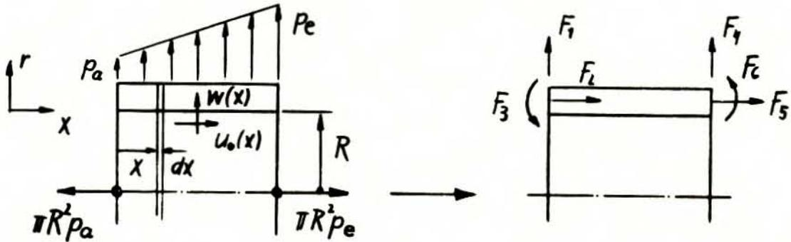
Abb. 10: Rohrelement mit geschlossenen Enden
