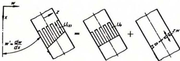
Abb. 2: Zusammenhang zwischen Biegung und Zug
