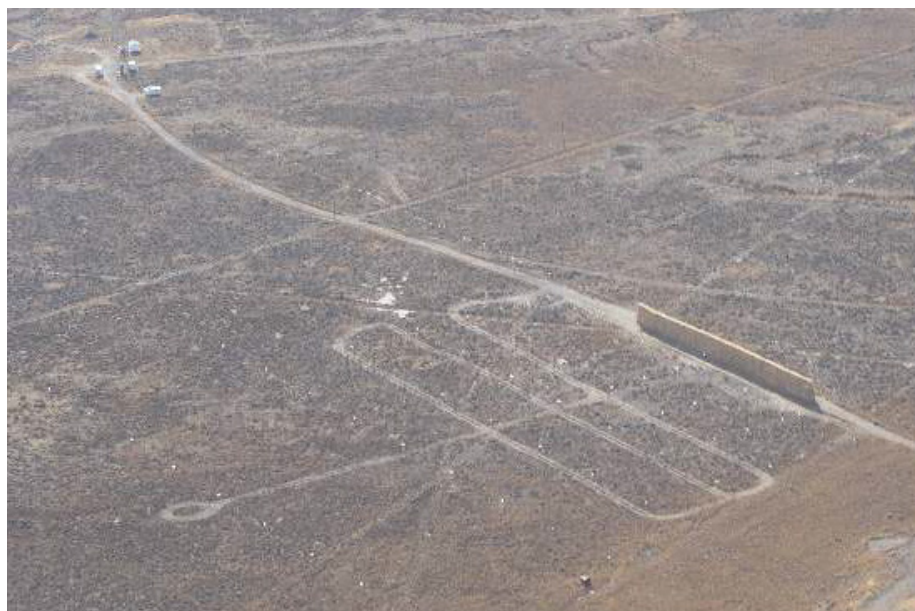
Abb. 3.5 Luftbild des NRTS Testgeländes mit simulierter Schallschutzwand (6 m hoch, 90 m lang), die aus je 1 t schweren Strohballen gebaut wurde (Quelle: /CLA 09/)
