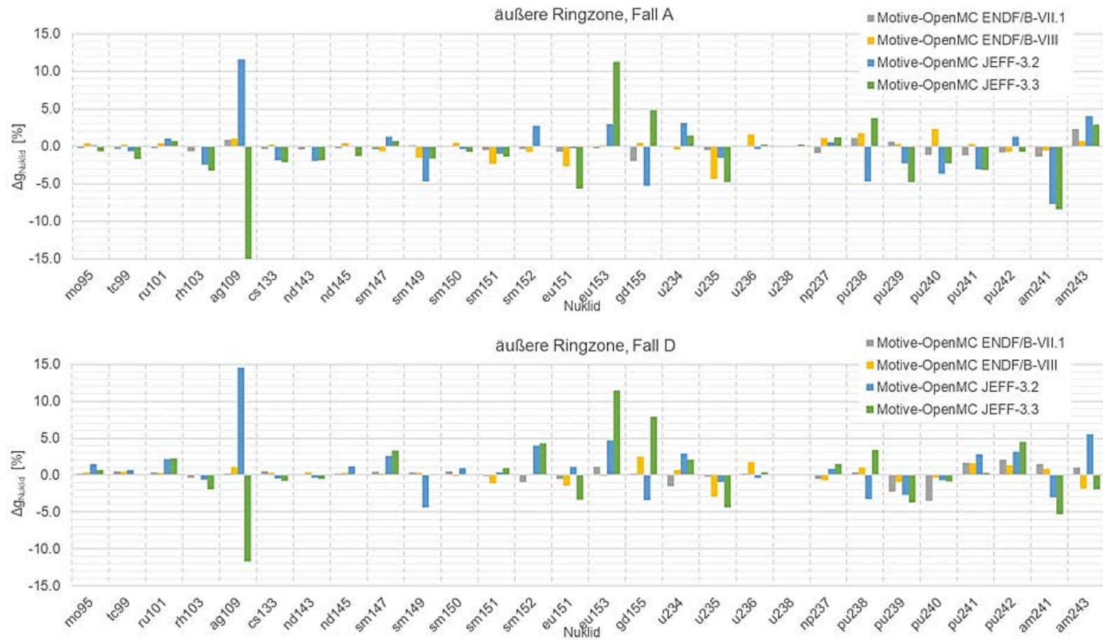
Abb. 6.13 Relative Abweichung der errechneten Nuklidkonzentrationen gegenüber MoTlve mit KENO-VI und der Bibliothek ENDF/B-VII.1 (2)
