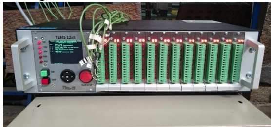
Abbildung 1: Am IW entwickeltes Temperaturmesssystem TEMS 12X8
