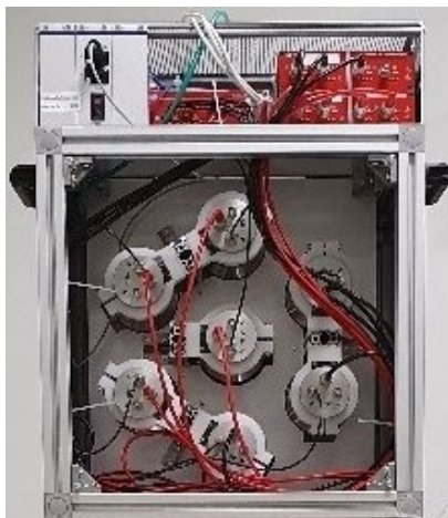
Abbildung 8: Rückansicht des RSL7, ein CeBr 3 -Detektor befindet sich im Zentrum, sechs EJ200-Szintillationsdetektoren sind jeweils 60° versetzt, kreisförmig um den CeBr 3 -Detektor angeordnet.
