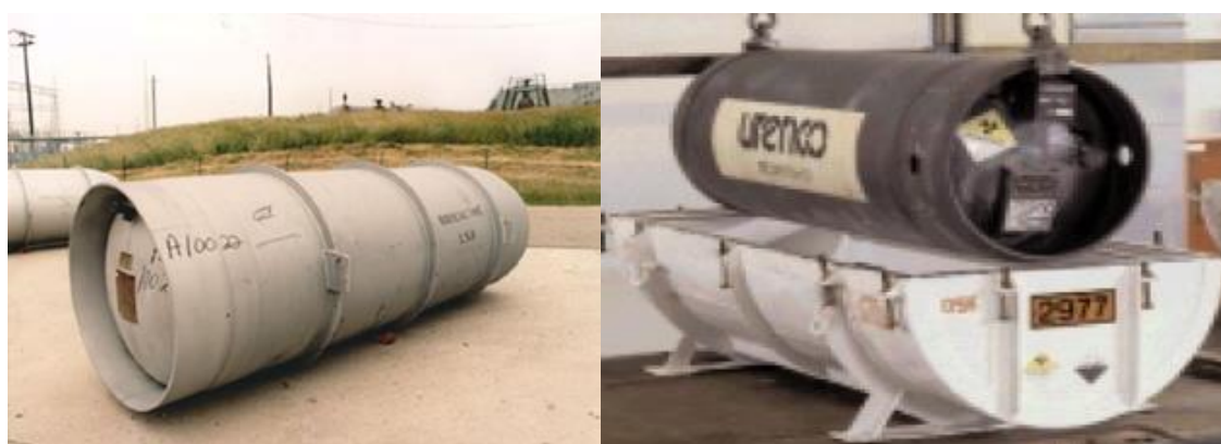
Abb. 5.6 48G-Lagerbehälter und 30B-Transportbehälter beim Verladen in den Overpack
