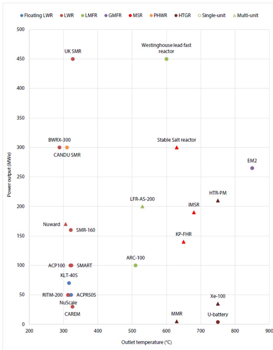
Abb. 3.1 Spektrum der elektrischen Leistung als Funktion der Kühlmittelauslasstemperatur für ausgewählte SMR/MMR-Reaktorkonzepte /OEC 21/
