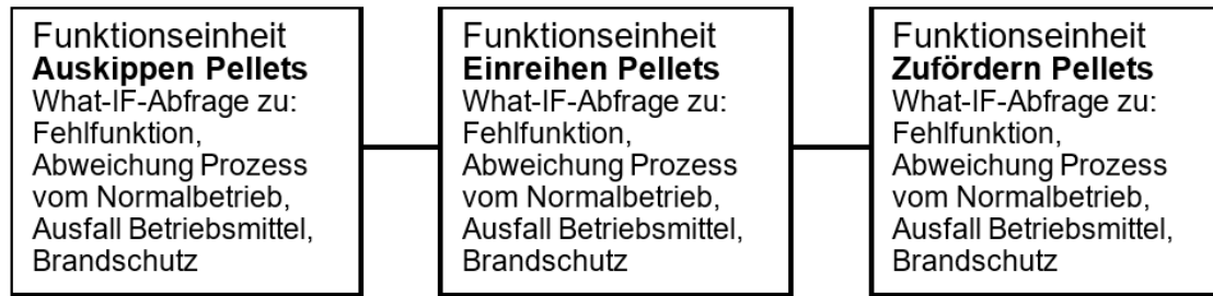
Abb. 3.4 Die ersten drei Funktionseinheiten des betrachteten, generischen Gesamtprozesses Pelletschleifen
