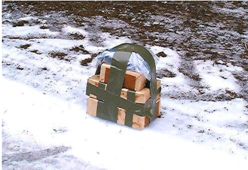
Abb. 5.1 Sprengladung mit aufgelegtem Farbpulverbeutel /GRS 04/
