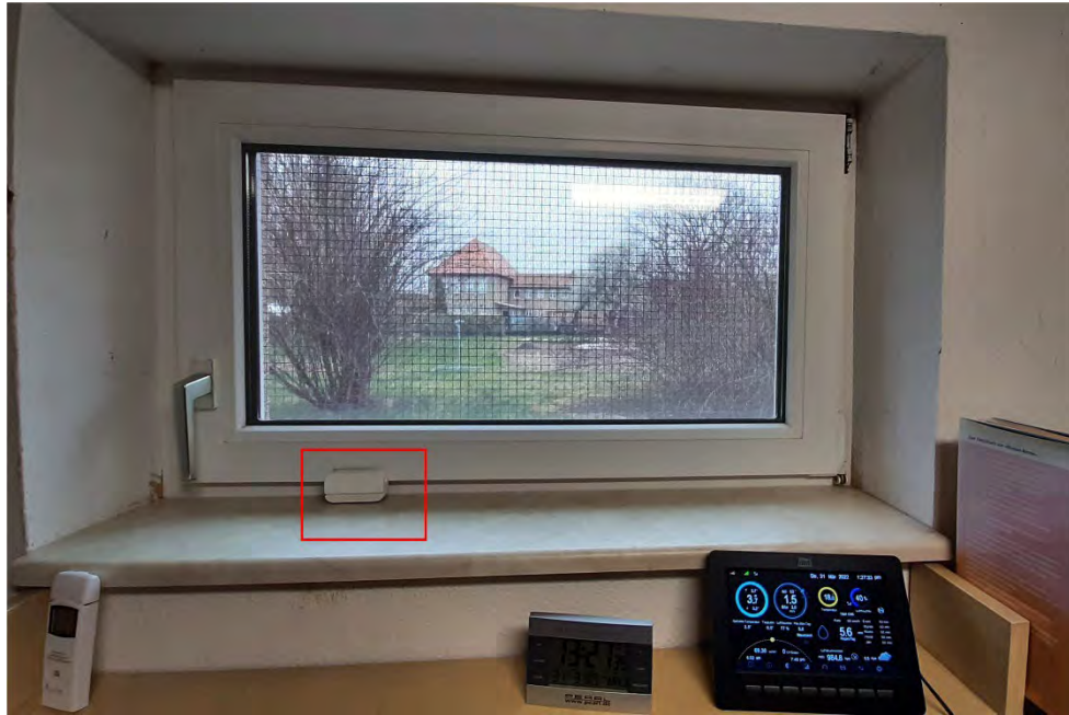
Abb. 2.32 Messobjekt Oberheldrungen, Fenster über dem Schreibtisch in Zimmer 1 mit Öffnungssensor (rot markiert) und Empfangsteil der Wetterstation
