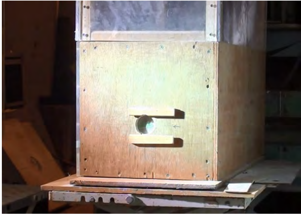
Abb. 7.2 Kiste gefüllt mit Sand; kreisrunde Aussparung für den Projektil-Aufprall
