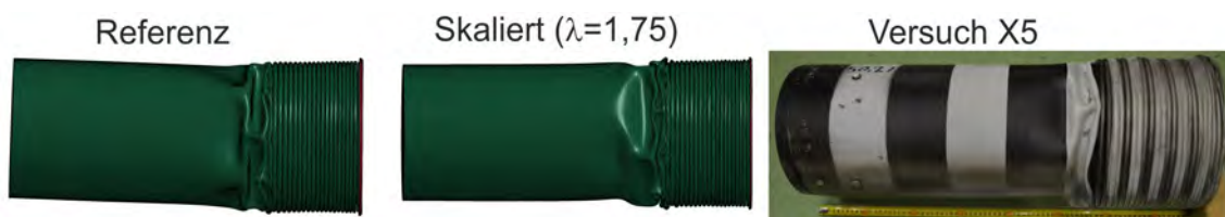
Abb. 6.6 Verformungen des Projektils in Skalenstudie zu Versuch X5
