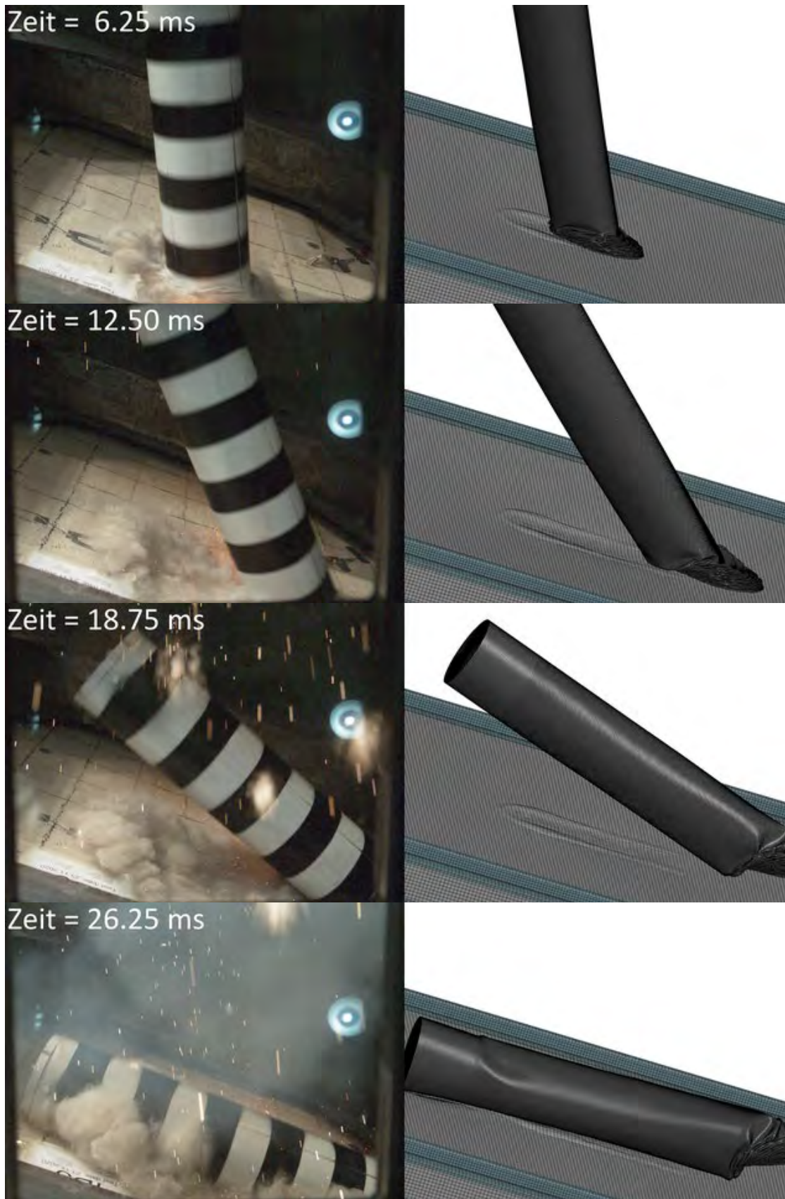
Abb. 4.10 Beobachtete und simulierte Verformungen des Projektils in Versuch IB3 zu ausgewählten Zeiten (Ansicht aus Vogelperspektive)
