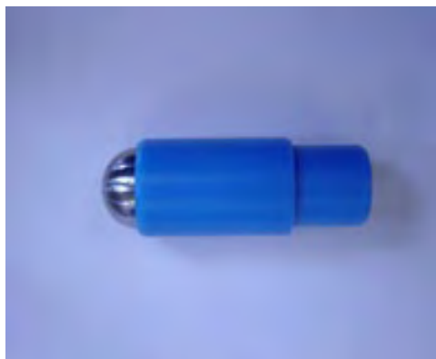
Abb. 7.3 Projektil bestehend aus Stahl-Nase und Nylatron®-Heckteil
