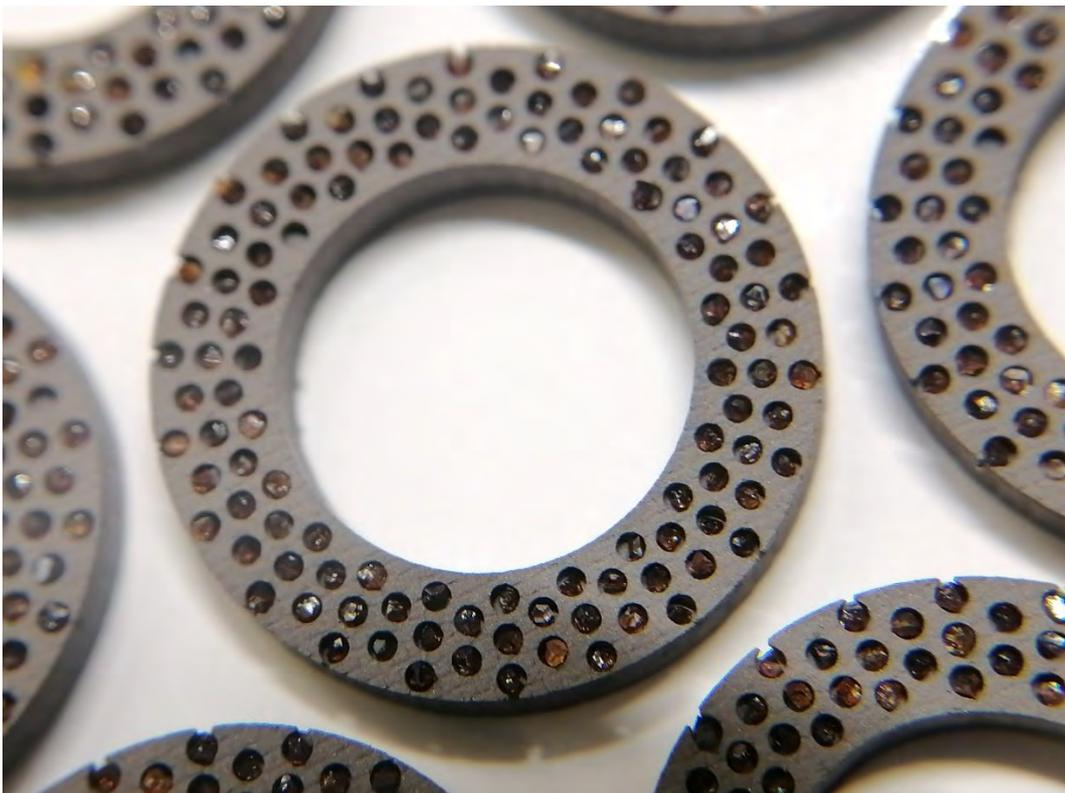
Abbildung 5: Nach dem CBN bestücken der Schneidperlenkörper im 3D Druck unter Laborbedingungen für die Schleifseil-Einsatztest. ©Fraunhofer IFAM
