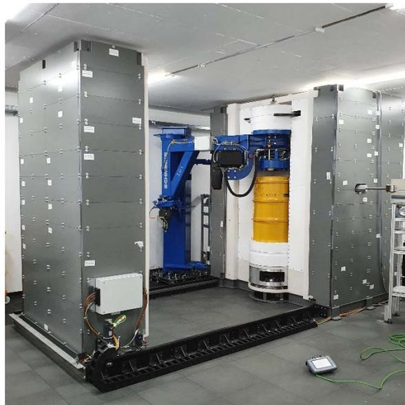
Die gesamte Anlage wurde Ende Oktober mit einem nicht radioaktiven Fass erprobt. Erstmals konnte ein Fass mit Neutronen bestrahlt und das entsprechende induzierte Gamma Spektrum aufgenommen werden. Die Kommunikation zwischen den verschiedenen Softwaremodulen wurde erfolgreich getestet. Am 26.10.2020 fand die Abnahme durch den Sachverständigen statt. Die Messanlage wurde mängelfrei abgenommen.
