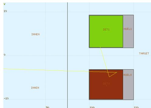
Abbildung 1: Koinzidenzereignis eines Photons (gelbe Linie) mit einer Energie von 662 keV, bestehend aus zwei Streuereignissen in Detektor 0 (DETO, Plastik-Szintillator) und einem Absorptionsereignis in Detektor 1 (DET1, CeBr<sub>3</sub>-Detektor).
