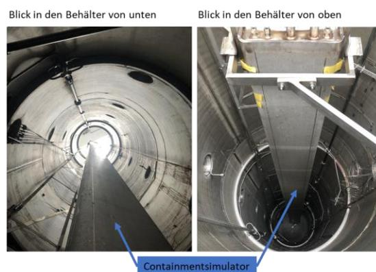
**Bild 3:** In der THAI-Anlage implementierter Containment-Simulator
