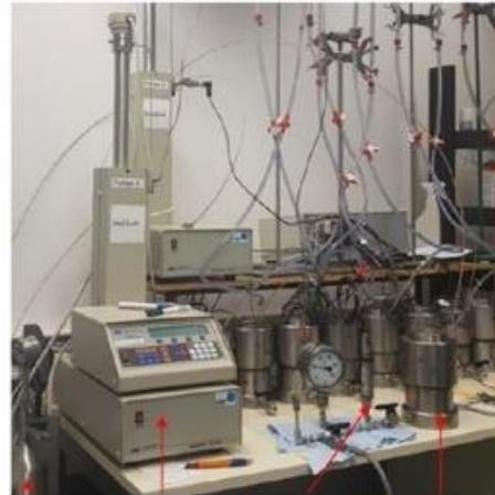
Gasbehälter Pumpe Drucksensor Druckzelle
