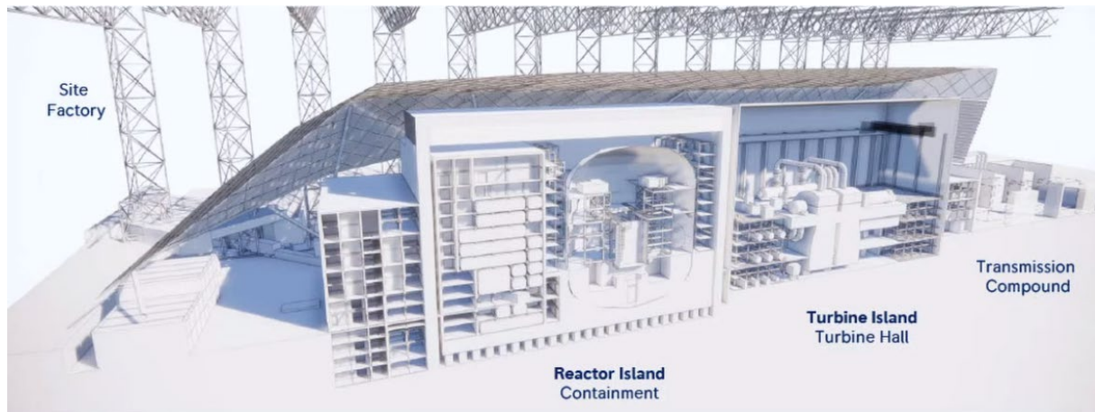
Abb. 5.1 Querschnitt durch die Reactor Island und das Turbinenhaus /RRC 22/
