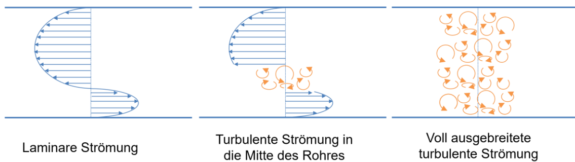
Abb. 2.30 Geschwindigkeitsprofile bei Gegenströmung – laminare Strömung, teilweise turbulente Strömung und voll ausgebreitete turbulente Strömung
