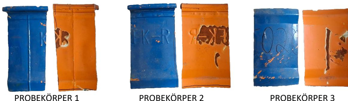
Abbildung 1 – Probekörper mit künstlichen Fehlern
