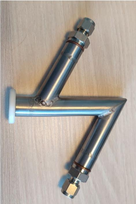
Abbildung 6: Neukonstruierte Testanordnung mit Swagelok-Anschlüssen und Detektoranordnung für optimierte Messung im Gastrom.
