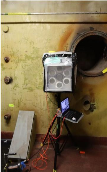
Abbildung 2: In Folie verpackte Kamera während einer Messung
