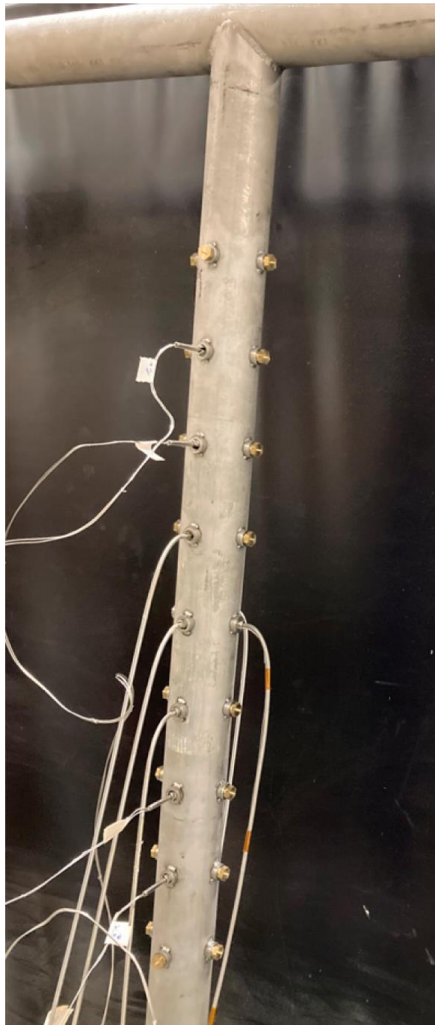
Abb. 3.14 Links: Mit Temperatursensoren bestücktes T-Stück des OECD-Benchmark Experiments. Bei jedem Test werden die Sensoren an zehn Positionen ausgelesen. Rechts: Temperatur T und normierte Temperatur T^* entlang der abzweigenden Leitung für verschiedene \Delta T_{\text{nom}} , aus /KRI 24/
