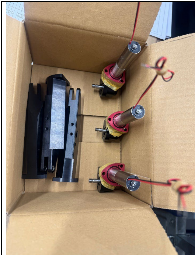
Schneckenradgetriebe mit Antriebsmotoren und Gehäuse
