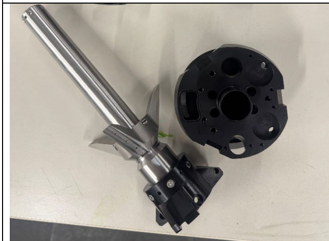
Zentrale Hohlwelle mit Aufnahme und E-Verteilerring.
