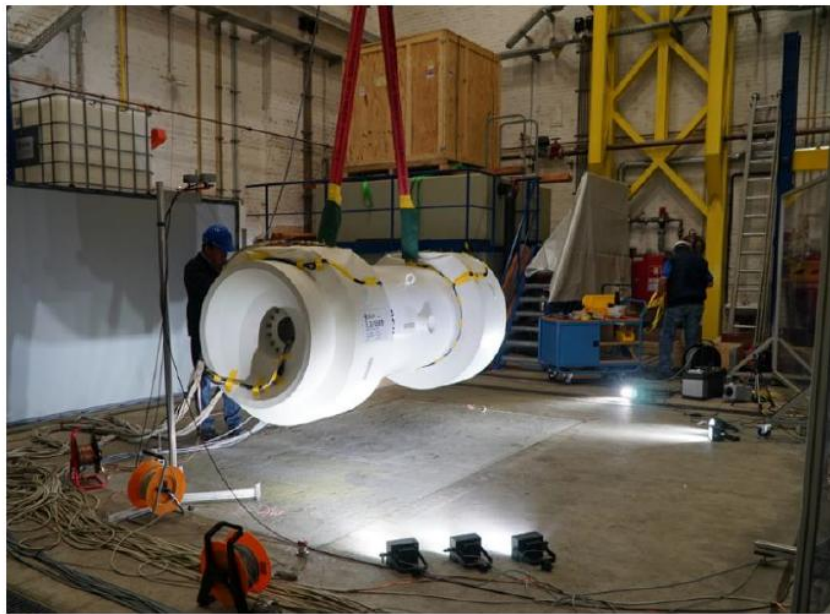
Abb. 2.7 Aufbau des 30 cm Fallversuchs durchgeführt auf dem Gelände der BAM /KAL 19a/
