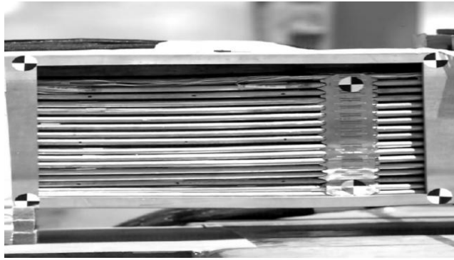
Abb. 3.18 Deformation der Brennstäbe und des Abstandshaltergitters aus dem experimentellen Fallversuch
