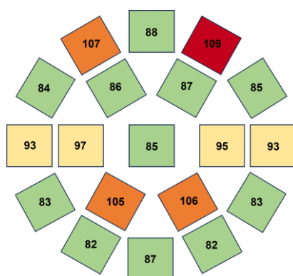
Abb. 4.9 Gefilterte Beschleunigungen der einzelnen Brennelemente aus einer 60°-Aufprallorientierung.
