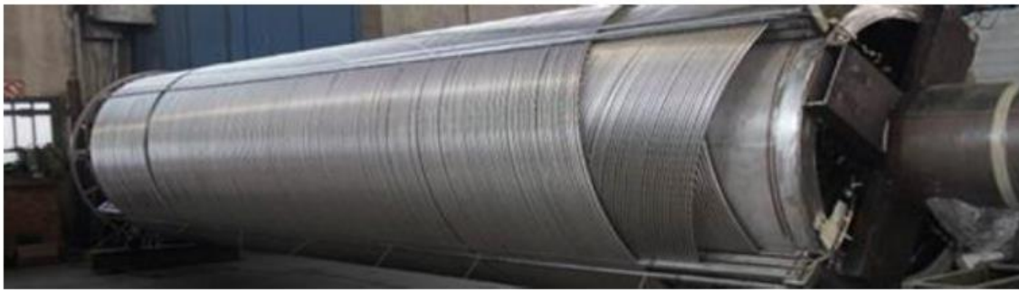
Abb. 3.7 Beide verflochtenen Dampferzeuger eines NuScale-Moduls; die heiße Steigleitung wird umschlossen /STU 17/
