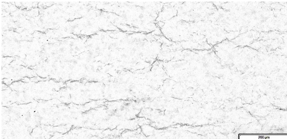
Abb. 4.17 LM-Aufnahme im Dunkelfeld von Hydriden in einer ungeätzten Zry-4-Probe
