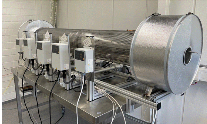
Abb. 5.2 Der HoKi-Ofen zur Hydrierung von 2,5 m langen Hüllrohren (Die hydrierte Länge beträgt 2,2 m)
