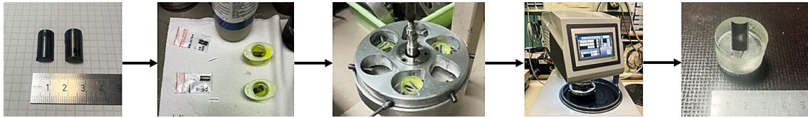
Abb. 4.16 Reihenfolge der metallographischen Präparationsschritte für eingebettete Hüllrohr-Proben
