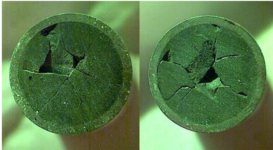
Abb. 3.1 Das präparierte Segment mit Hüllrohr und Kernbrennstoff
