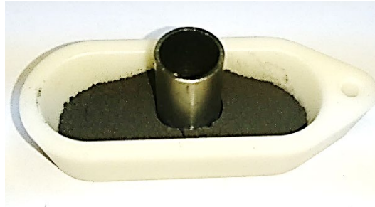
Abb. 4.10 Zry-4-Hüllrohrprobe in \text{ZrH}_2 -Pulver als Wasserstoffreservoir
