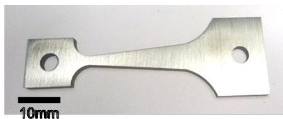
Abb. 4.25 Nicht hydrierte Zirkonium-Flachprobe für die Untersuchung des Spannungseinflusses auf die Wasserstoff-Löslichkeit in Zirkonium
