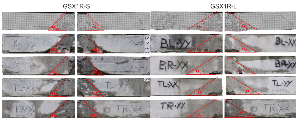
Abb. 8.9 Schadensbilder in Plattenquerschnitten in GSXR-Versuchen
