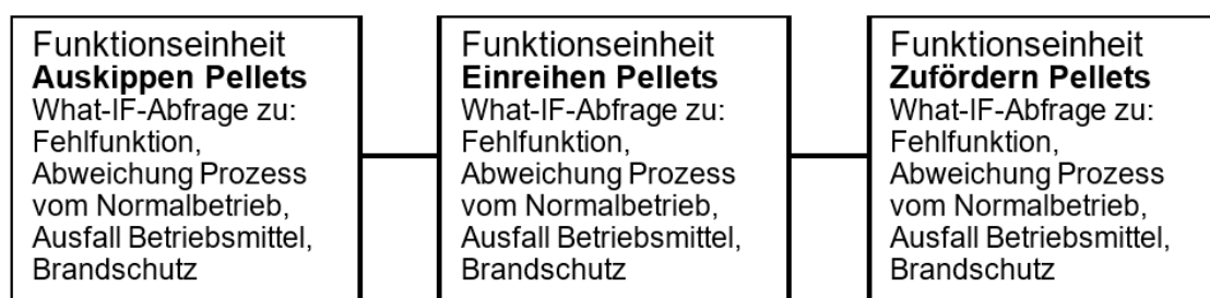
Abb. 2.4 Die ersten drei Funktionseinheiten des betrachteten, generischen Gesamtprozesses Pelletschleifen
