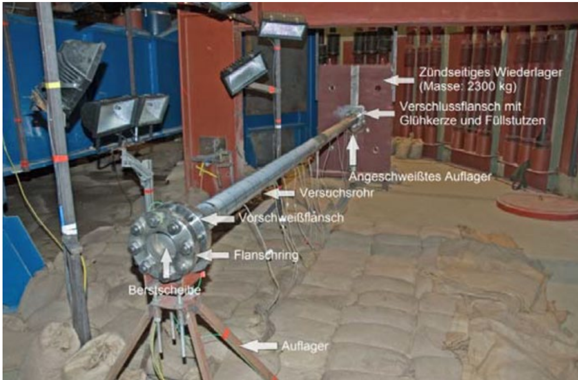
Abb. 3.42 Versuchsaufbau der Offermanns-Versuche
