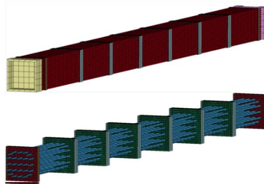
Bild 4: FEM-Modell eines Brennelements (oben) und Darstellung ohne Kopfplatte, Fußplatte und Brennstäbe zur besseren Sichtbarkeit der inneren Strukturen (unten)
