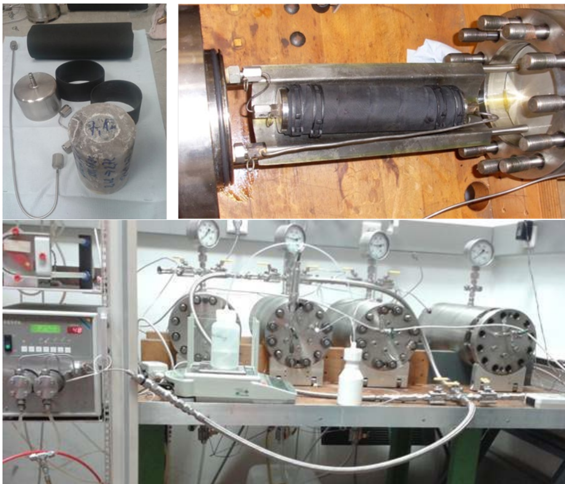
Abb. 3.7 Versuchsaufbau zur Durchführung der Permeabilitätsmessungen von kombinierten Prüfkörpern in Hassler-Zellen (Manteldruckzellen)
