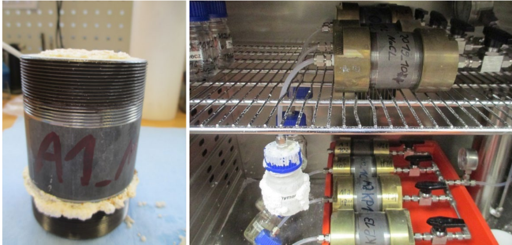
Abb. 4.16 Foto eines monolithischen Prüfkörper des Sorelbetons AX nach Durchströmung bei 60°C bis zum hydraulischen Versagen (links); Auskristallisation der Lösung am Auffanggefäß nach deren Überlauf
