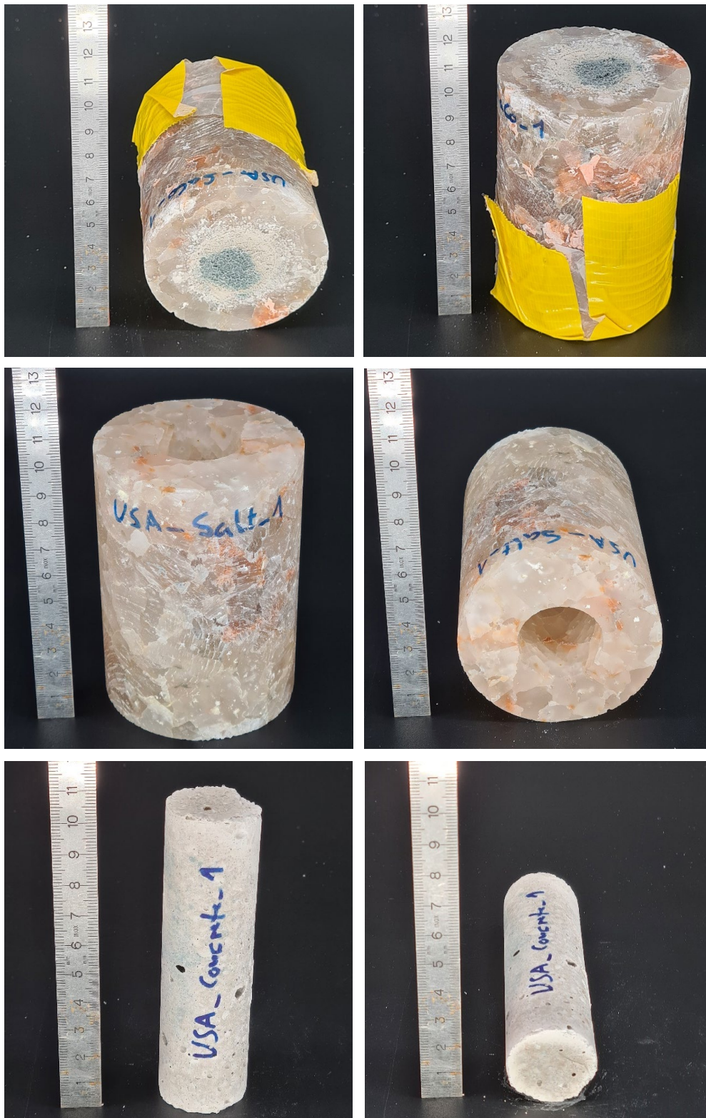
Abb. 4.49 Prüfkörper aus der WIPP: zementierte Salzhohlzylinder mit Salzbeton der Rezeptur der WIPP (oben), Salzhohlzylinder hergestellt aus Salzbohrkernen der WIPP (Mitte), Salzbeton der Rezeptur WIPP (unten)
