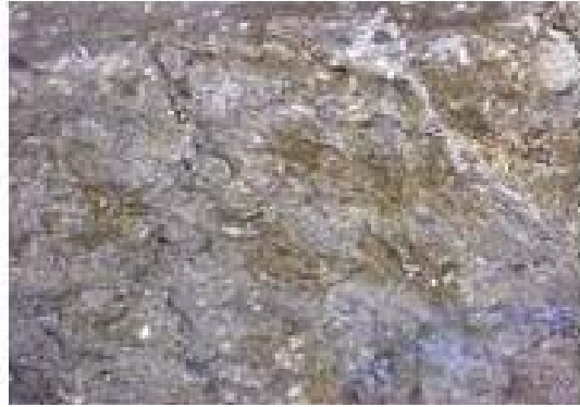
Abb. 2.4.14: Ausschnittsphoto der Probe NA4-4 mit Tonmineralen
