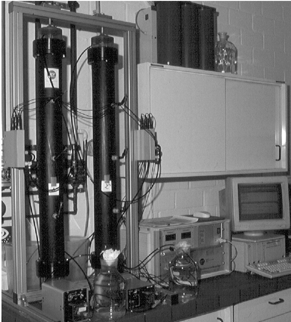
Abb. A.2 Aufbau einer Säulenelutionsanlage zur Untersuchung unverfestigter Abfallproben
