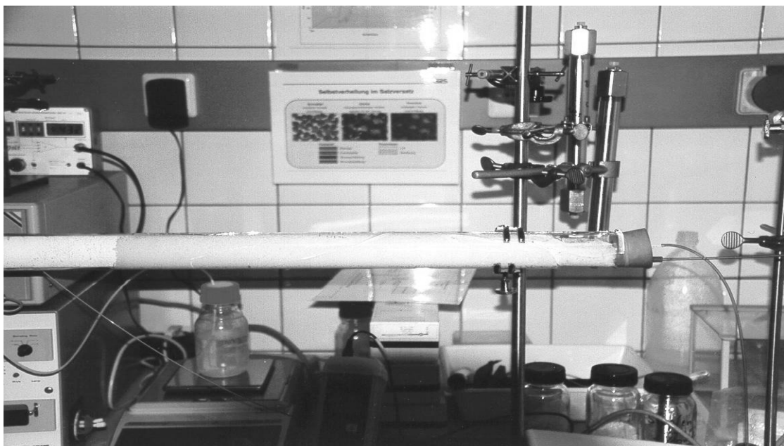
Abb. 7.1: Säulenversuch in einer horizontalen Glassäule zur optischen Beobachtung des Lösungsfortschritts und der Stopfenbildung im Salzversatz
