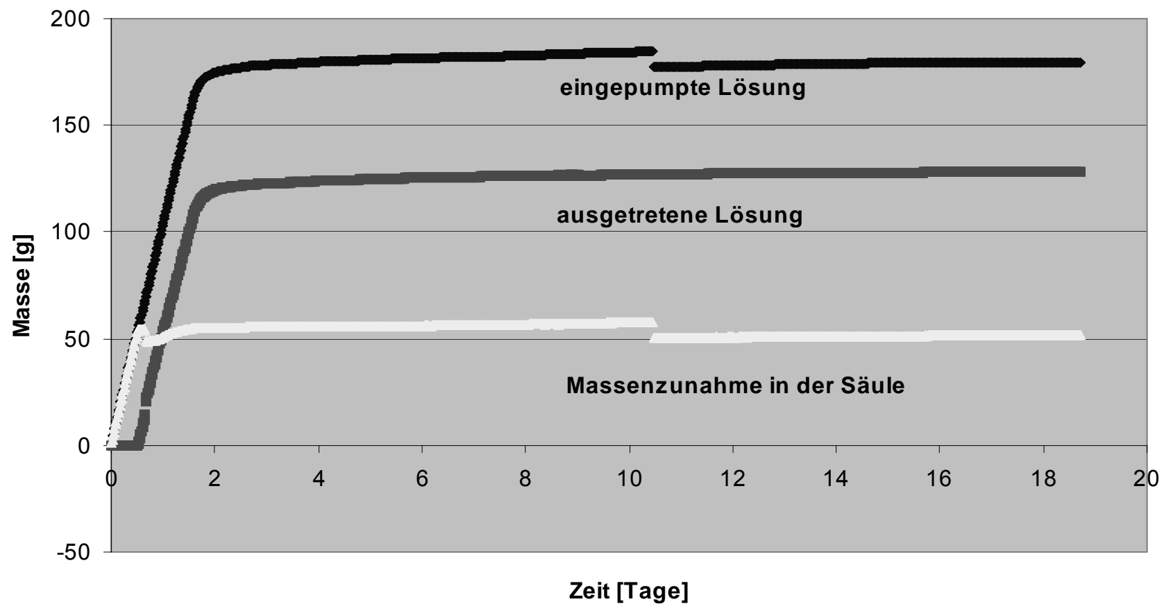
Abb. 7.6: Hochdrucksäulenversuch HV-7 mit getrocknetem Kieserit, Sylvin und IP21-Lösung - in den Versatz eingedrungene, durchgetretene und verbliebene Lösungsmasse
