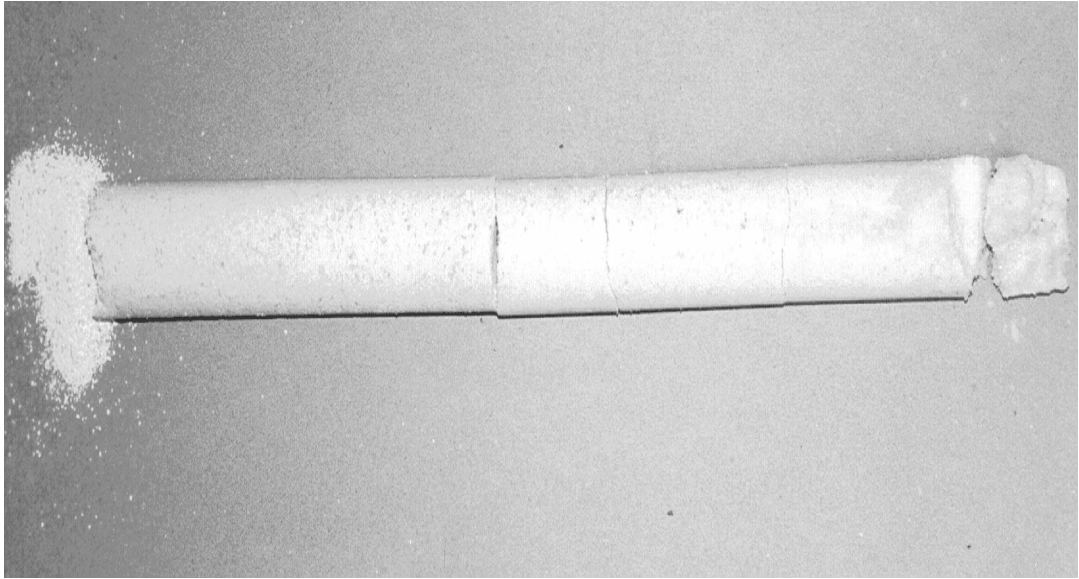
Abb. 7.4: Füllung nach Entfernen der Glassäule (Abb. 7.1) – Gesamtansicht des Versatzmaterials aus der Glassäule, rechts Eintritt der Lösung, Mitte Stopfenbildung infolge Reaktion mit eingedrungener Lösung, links loses, unreaktiertes Versatzmaterial infolge fehlender Lösung, deren Fortschreiten durch die Stopfenbildung verhindert wurde
