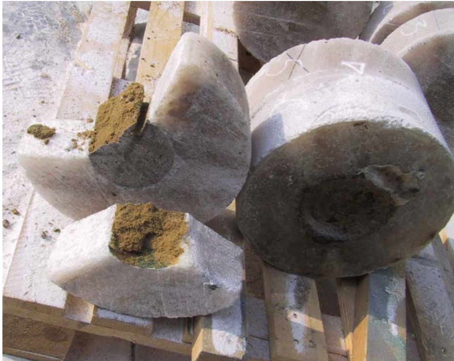
Abb. 5.22 Aufgeschnittene Scheibe mit Sand-Ton-Füllung
