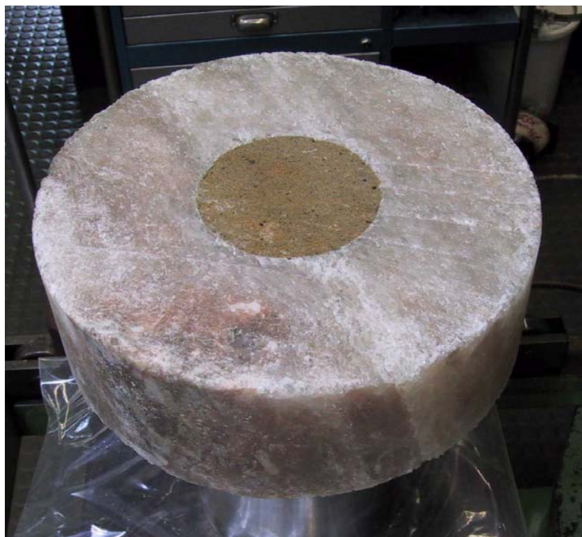
Abb. 5.23 Scheibe mit Salzring und Sand-Ton-Füllung
