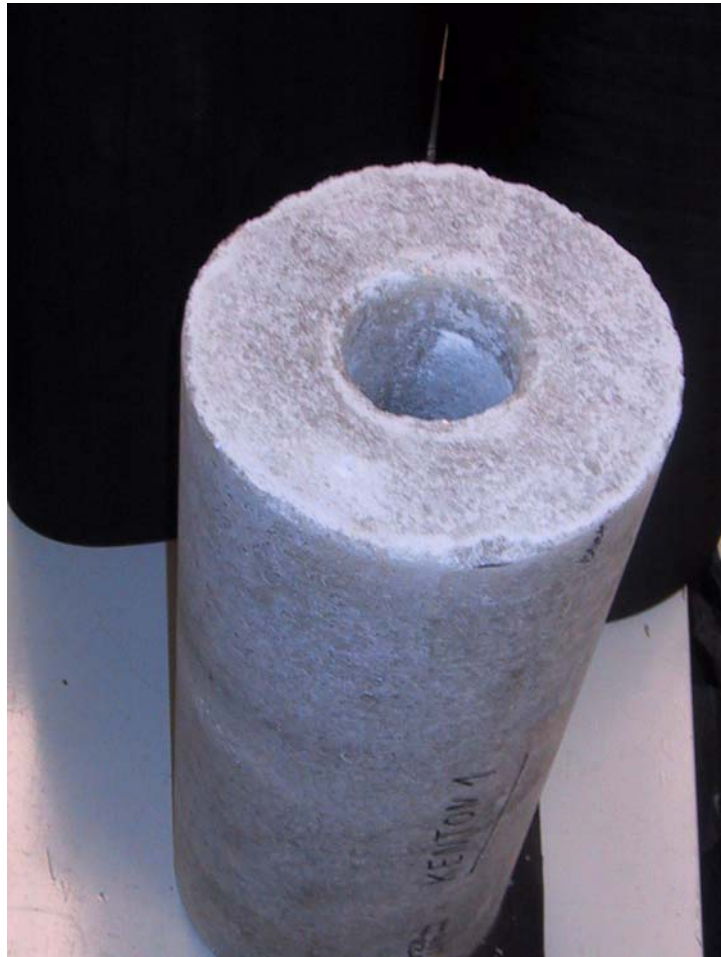
Abb. 3.3 Großkalibriger Steinsalz Kern mit durchgehender Zentralbohrung
