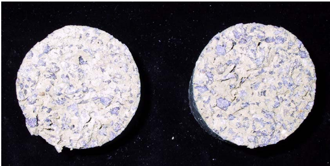
Abb. 5.18 Probe ST75/25.K6 nach Ausbau; Sättigungsmedium: Wasser
