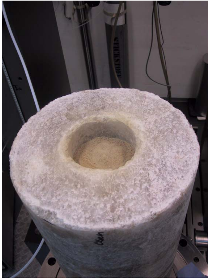
Abb. 3.4 Großkalibriger Steinsalz Kern, Zentralbohrung teilgefüllt mit einer Sand-Ton-Mischung 90/10, locker eingebracht und schichtweise verdichtet
