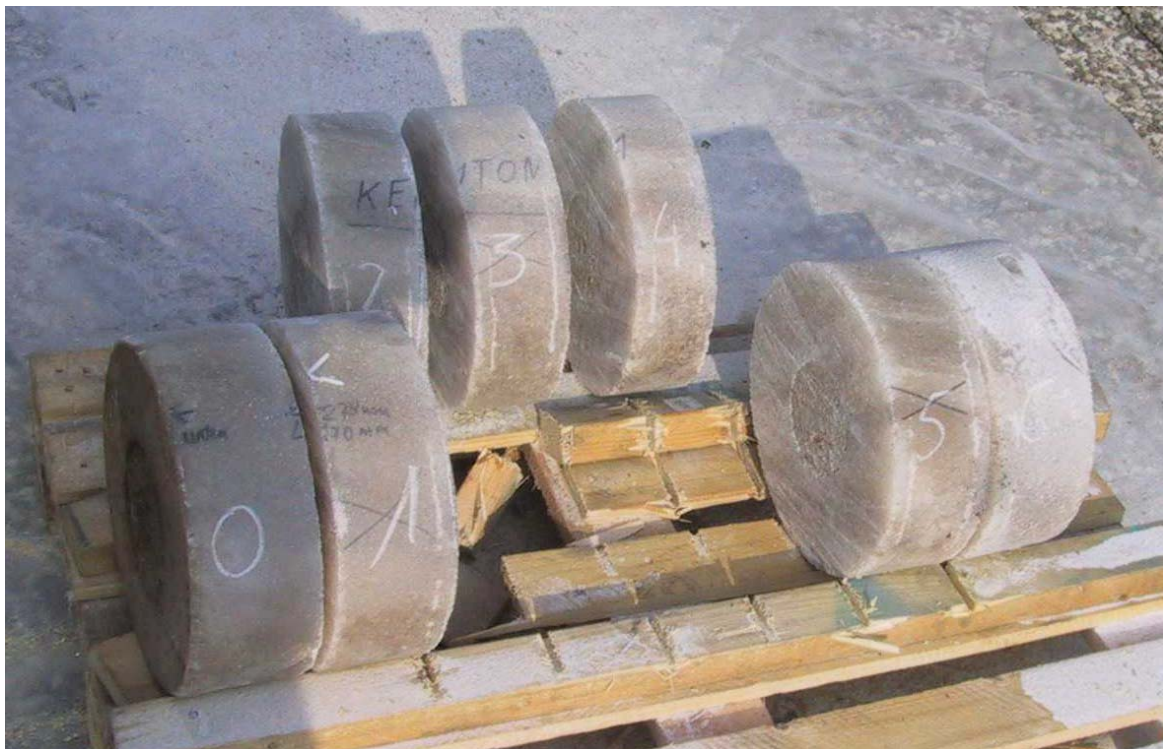
Abb. 5.21 In Scheiben zersägte Probe
