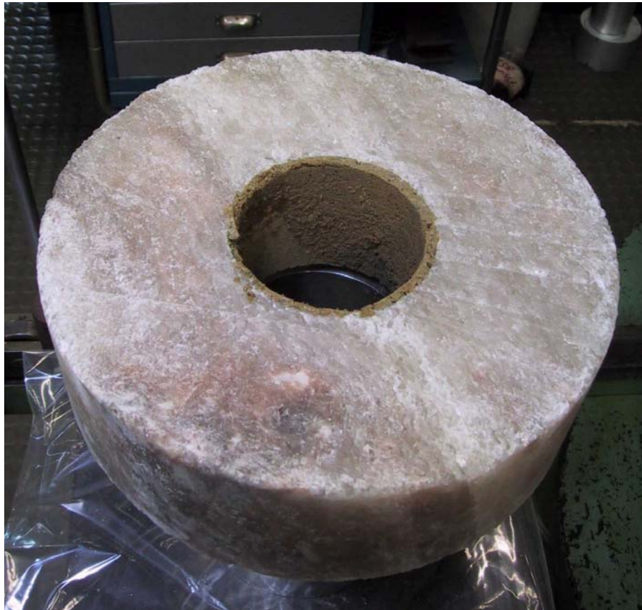
Abb. 5.24 Salzring nach Ausdrücken der Sand-Ton-Füllung
