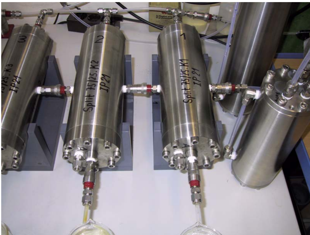
Abb. 4.2 Zusammengebaute Messzellen. Rechts stehend: Flasche für Wasser- und Laugenbeaufschlagung bzw. Befeuchtung des Stickstoffs
