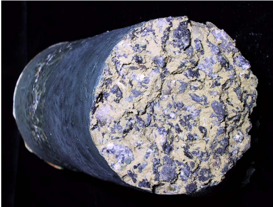
Abb. 5.19 Probe ST75/25.1 nach Ausbau; Sättigungsmedium: Q-Lauge (IP 21)
