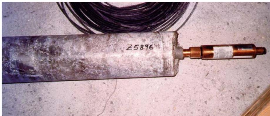
**Abb. 4-10:** Bohrkern mit eingebauter Triaxialsonde und Bohrlochcomputer
