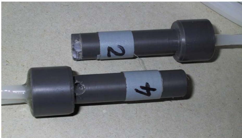
**Abb. 4-21:** In den Bohrlöchern eingesetzte Stopfen
