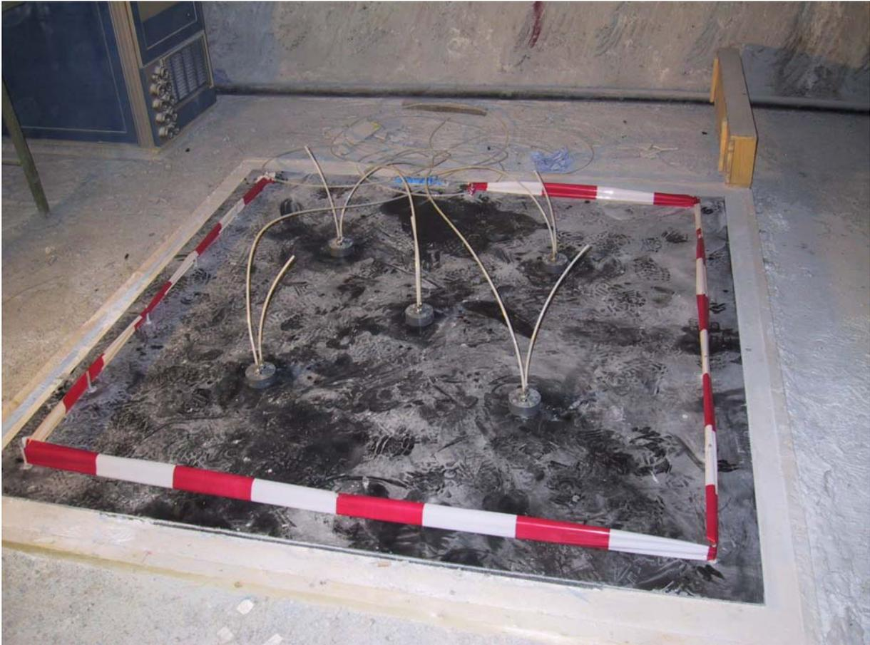
**Abb. 4-22:** Auf der Sohle der AHE-Strecke installierte Kunststoffplatte mit den Anschlussleitungen für Injektionstests
