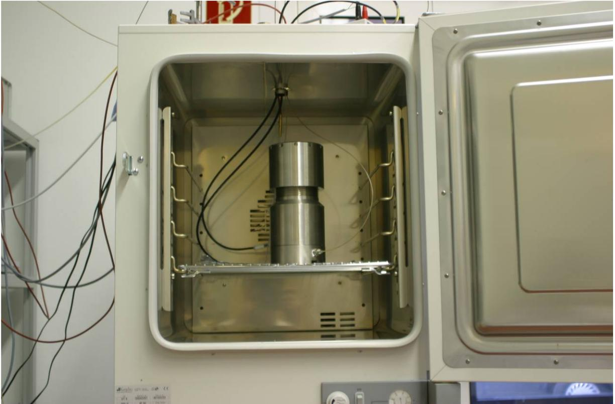
**Abb. 6.7** Kleine zylindrische Zelle aus Titan in einem Wärmeschrank zur Messung von Quelldrücken bei erhöhten Temperaturen
