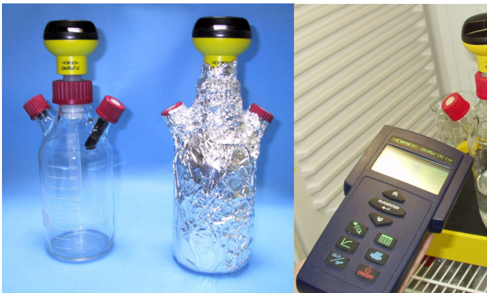
Abb. 1: Versuchsflaschen mit Druckmessköpfen zur Bestimmung der Gasfreisetzung aus Abfällen.
