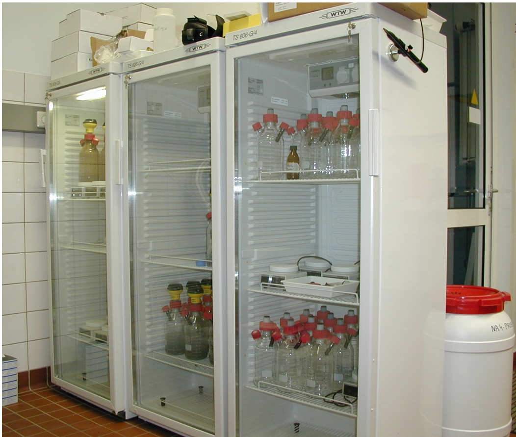
Abb. 2: Thermoschränke zur Temperierung der Gasmessflaschen auf 25 bzw. 35 \pm 1^\circ\text{C}
