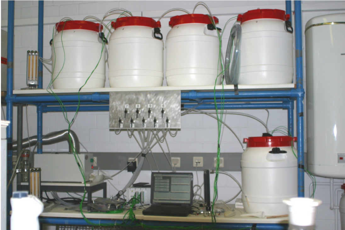
Abb. 7: Messstand für Technikumsversuche: Oben und unten rechts: abfallgefüllte Fässer, mittig: Gasregelstation, links: Gasdurchflussmessung, mitte unten: Notebook zur Messwertaufnahme
