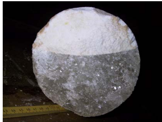
Abb. 6.9 (links): Bohrkern GB-1c mit der Kontaktzone von SVV/Gebirge aus dem Auflockerungsbereich der Strecke. (rechts): Querschnitt durch den Bohrkern.
