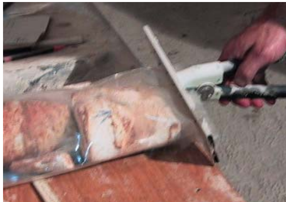
Abb. 6.3 (links): Bohrkronen und ausgebauter Kern. (rechts): Kern wird zur Lagerung in Folie eingeschweißt.
