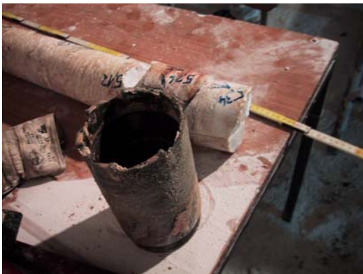
Abb. 6.3 (links): Bohrkronen und ausgebauter Kern. (rechts): Kern wird zur Lagerung in Folie eingeschweißt.
