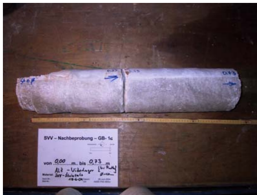
Abb. 6.9 (links): Bohrkern GB-1c mit der Kontaktzone von SVV/Gebirge aus dem Auflockerungsbereich der Strecke. (rechts): Querschnitt durch den Bohrkern.
