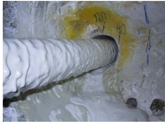
Abb. 6.4 (links): Staubentwicklung während des Bohrens. (rechts): Bei Anbohren einer Laugentasche vermischt sich die Lauge mit dem Bohrmehl und haftet als Bohrschlamm auf dem Kernrohr. Im weiteren Verlauf härtet der Bohrschlamm aus und bildet eine feste Kruste.
