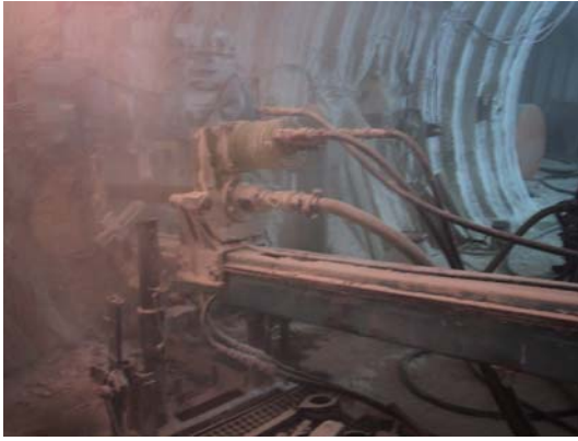
Abb. 6.4 (links): Staubentwicklung während des Bohrens. (rechts): Bei Anbohren einer Laugentasche vermischt sich die Lauge mit dem Bohrmehl und haftet als Bohrschlamm auf dem Kernrohr. Im weiteren Verlauf härtet der Bohrschlamm aus und bildet eine feste Kruste.
