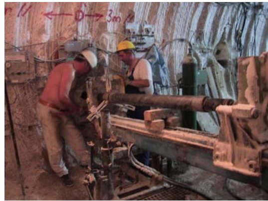
Abb. 6.2 (links): Steuerstand der NASOVIA-Bohranlage. (rechts): Ausbau des Kernrohres.
