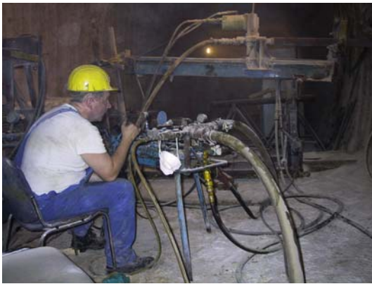
Abb. 6.2 (links): Steuerstand der NASOVIA-Bohranlage. (rechts): Ausbau des Kernrohres.
