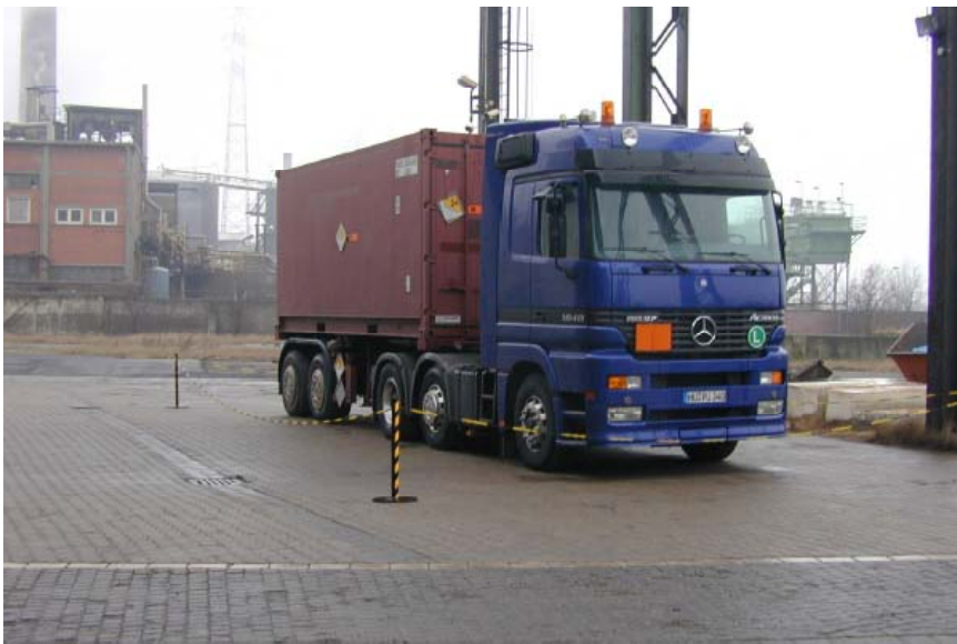
Abb. 6.8 Straßentransportfahrzeug für radioaktive Abfälle (Quelle: GNS)
