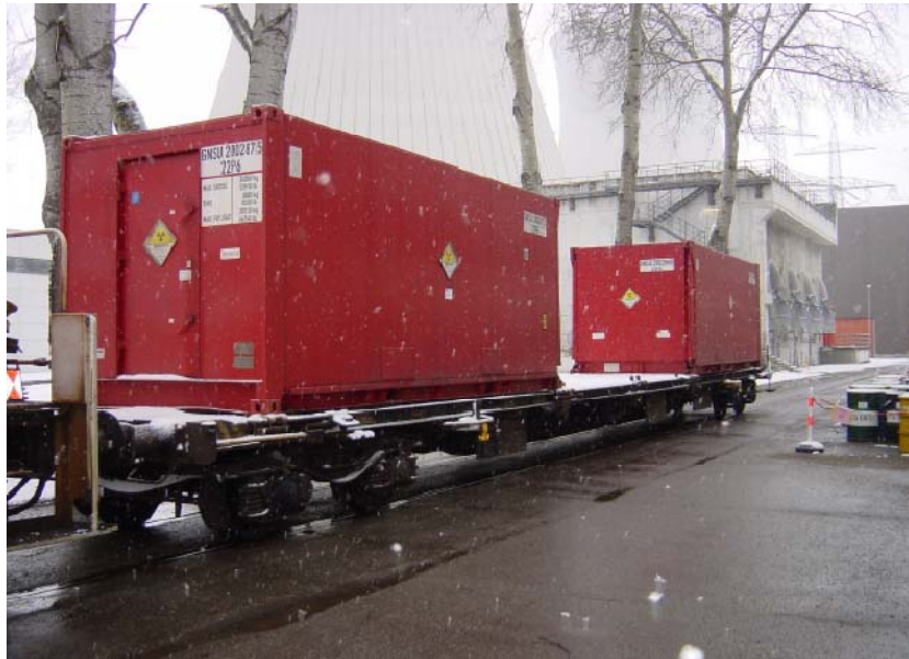
Abb. 6.7 Tragwagen für Großcontainer/Wechselbehälter der Baureihe Sgjs 712 (Quelle: GNS)
