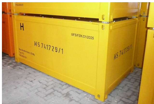
Abb. 4.4 Konrad-Container Typ IV (Quelle: HDB)
