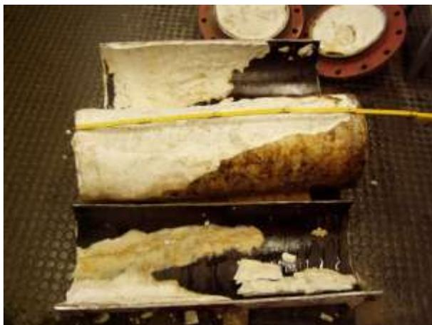
**Abb. 7.6** SVV-Probekörper aus Rohr 2 mit IP21-Lösung nach Aufflexen des Rohres
