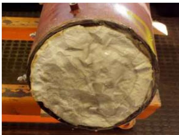
**Abb. 7.4** Beim Abtrennen der Kopfenden der Rohre platzten die abgeflexten Deckel mit fest anhaftendem SVV ab
