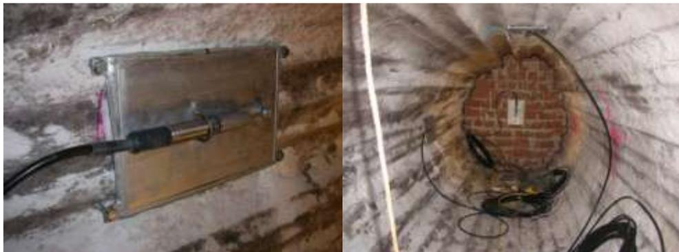
**Abb. 7.23** Glötzl-Druckaufnehmer an der Bohrlochwand und auf der permeablen Lochsteinmauer
