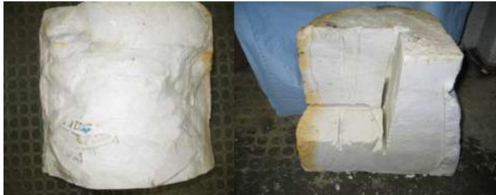
**Abb. 8.10** Links: Nach Reaktion mit Tachhydrit-Lösung ausgehärtetes SVV aus einem großkalibrigen Druckrohr in der Asse – Probe nach Ausbau aus dem Druckrohr; Rechts: Innenansicht des SVV-Probekörpers aus einem großkalibrigen Druckrohr in der Asse nach Reaktion mit Tachhydrit-Lösung – es hat sich ein sehr festes, dichtes und augenscheinlich homogenes Material ausgebildet
