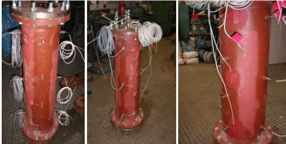
**Abb. 7.1** Instrumentierung der Rohre mit sechs Temperaturlaufnehmern im Rohrinnern (Bild links), drei davon am Rand und drei in der Mitte sowie mit PT-100 Temperaturfühlern auf der Oberfläche der Rohre (Bild links) und mit drei Druckaufnehmern, in der Mitte der Rohre (Bild Mitte)
