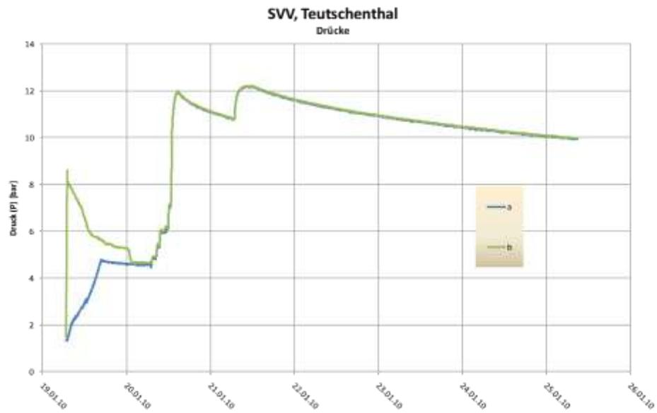
**Abb. 9.8** Druckverlauf beim Laugeninjektionstest (Injektionsleitung b am 19.01.2010 verstopft; Konstantdruckphase am 21.01.2010 zwischen ca. 9:00 Uhr und 12:15 Uhr)
