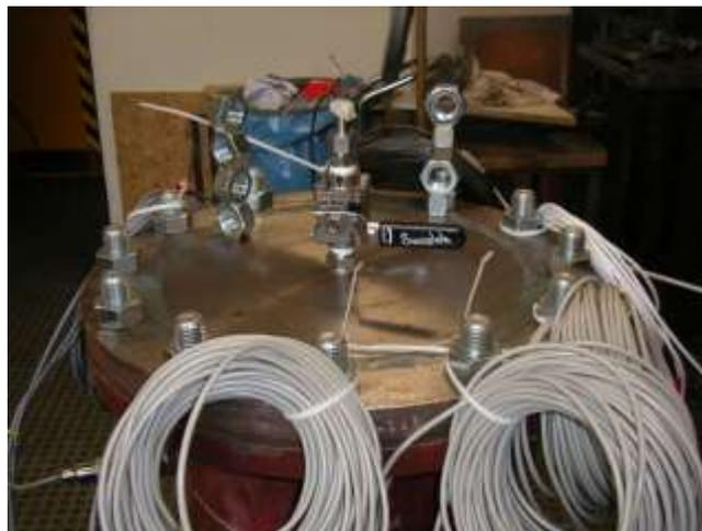
**Abb. 7.2** Rohrdeckel und Ventil für das Einfüllen der Lösung. Ein gleiches Ventil befand sich am andern Ende des Rohres für den Lösungsaustritt.
