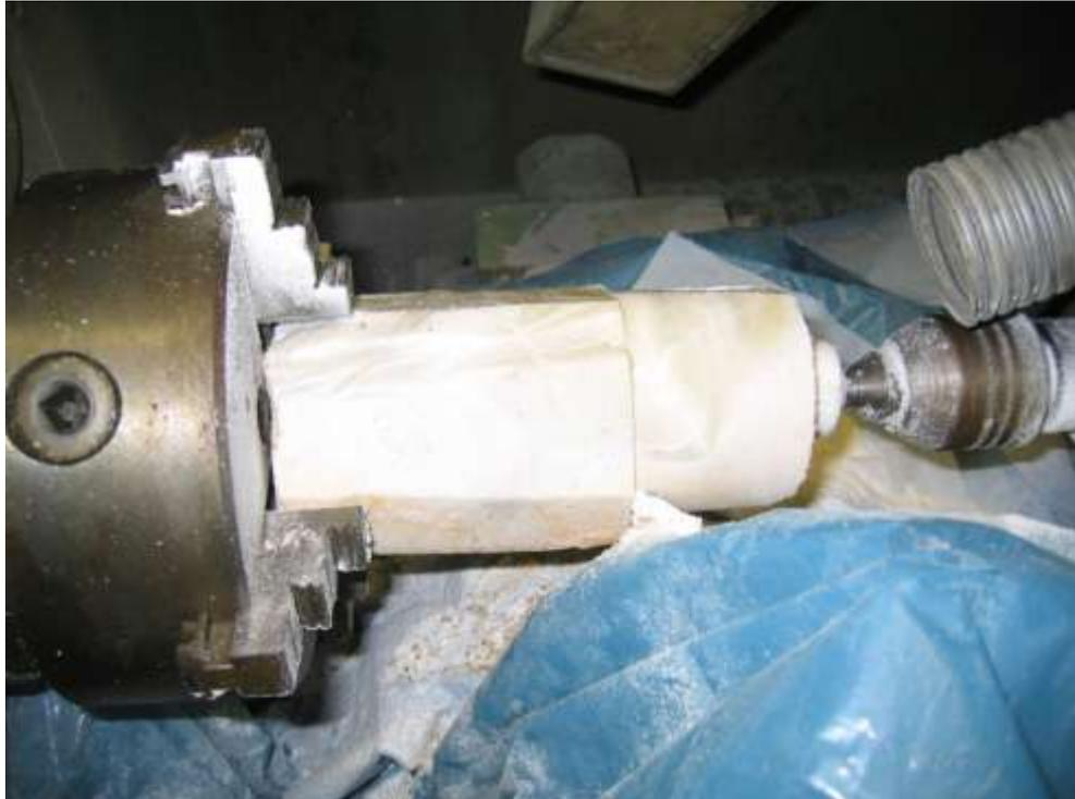
**Abb. 8.11** Nach Reaktion mit Tachydrit-Lösung ausgehärtetes SVV aus einem großkalibrigen Druckrohr in der Asse – Probenvorbereitung für geometrische Festigkeitsuntersuchungen
