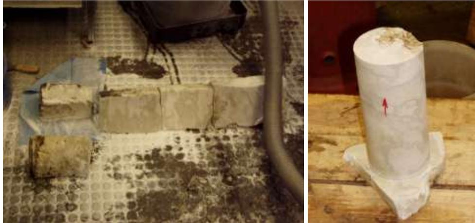
**Abb. 7.7** SVV-Material aus Rohr 2 mit IP21-Lösung mit optisch erkennbaren Inhomogenitäten
