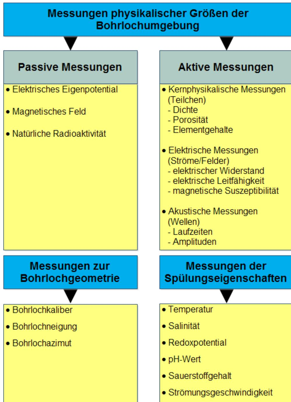
**Abb. 3.4** Übersicht über die unterschiedlichen Messungen in einem Bohrloch (basierend auf /KNÖ 05/)
