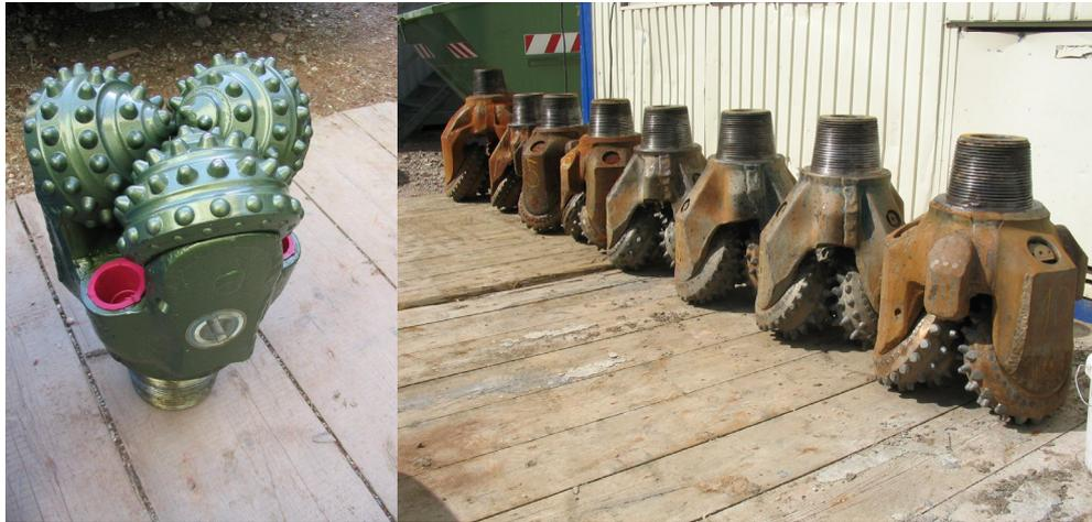
**Abb. 3.3** Seiten- und Vorderansicht eines im Rotary-Verfahren verwendeten Rollenmeißels (Quelle: FRE<sup>3</sup>)
