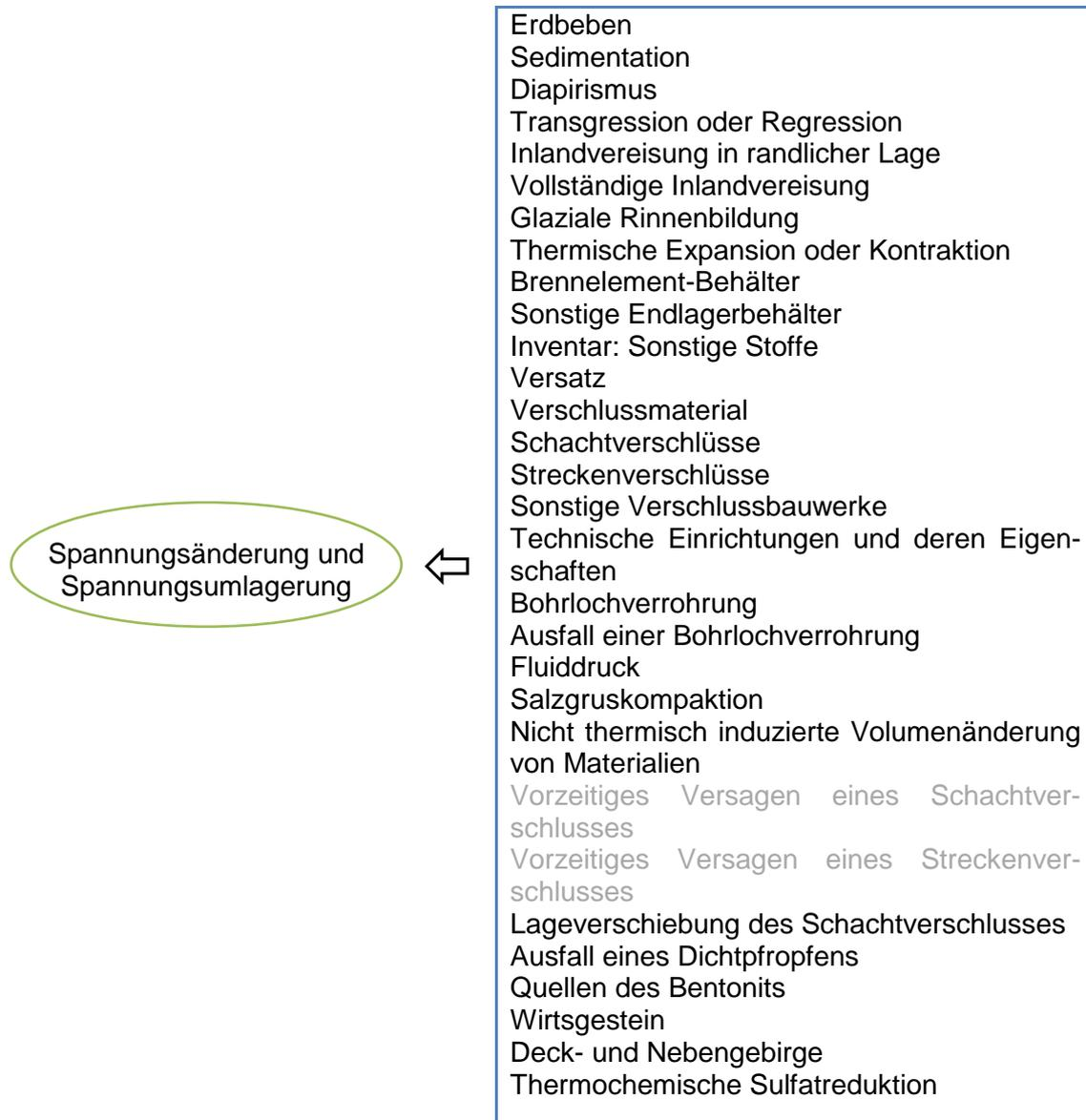
**Abb. 2.19** Einflussfaktoren auf Spannungsänderungen und -umlagerungen
