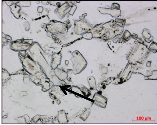
Abb. 3.4 Interkristalline KW im Dünnschliff (Foto: BGR, Bohrung RB 648, Hauptsalz Gorleben, /HAM 12/)
