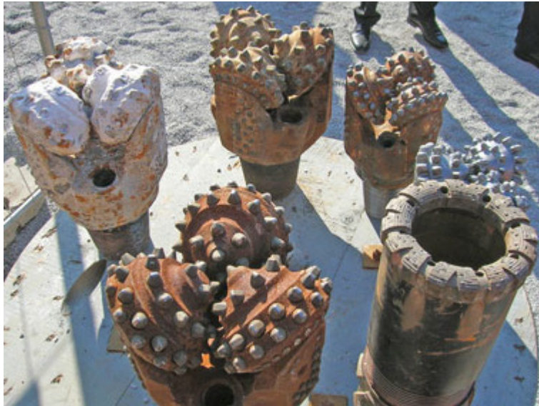
Abb. 3.1 Verschiedene Bohrmeißel (rechts unten im Bild ist eine diamantbesetzte Bohrkronen dargestellt, die es erlaubt, Bohrkerne aus dem Gestein zu erbohren) /GUB 14/
