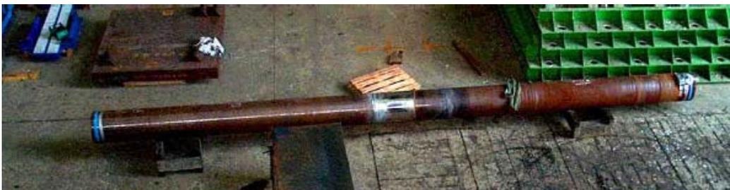
**Abb. 3.1:** ADIMEW - Versuchskörper vor dem Test (aus /MAR 03/)
